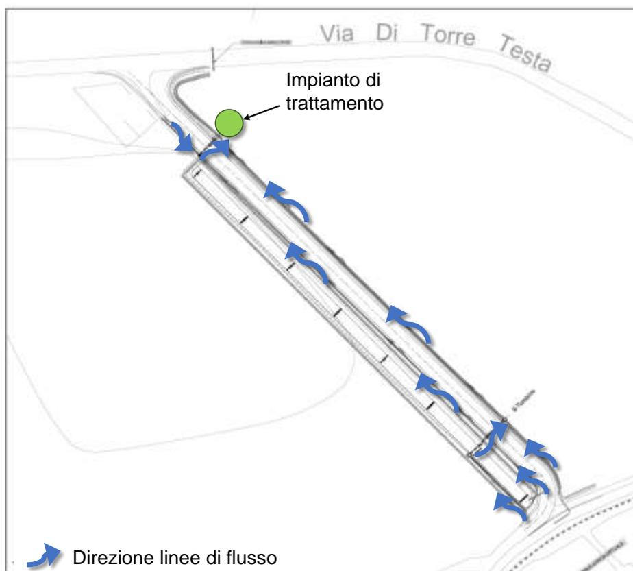
Figura 4-11 Schematizzazione sistema raccolta e trattamento acque meteoriche
