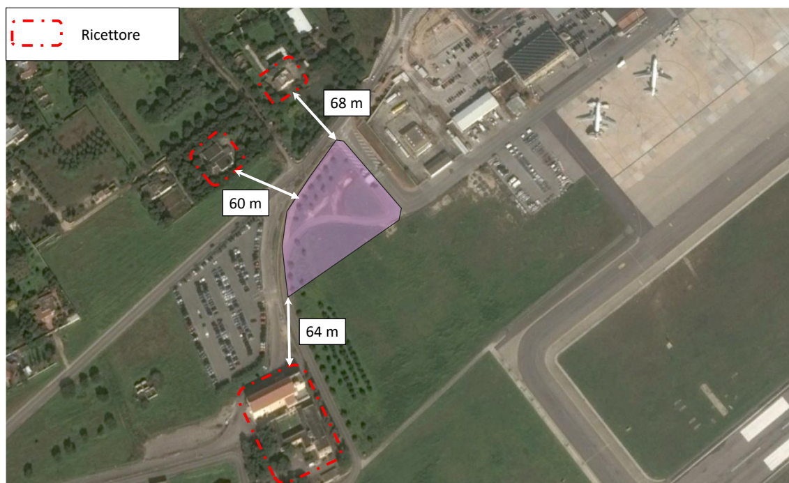
Figura 6-54 Localizzazione di ricettori rispetto le attività di scotico e sbancamento previste per la realizzazione della nuova area pavimentata in clb per la sosta dei mezzi rampa
