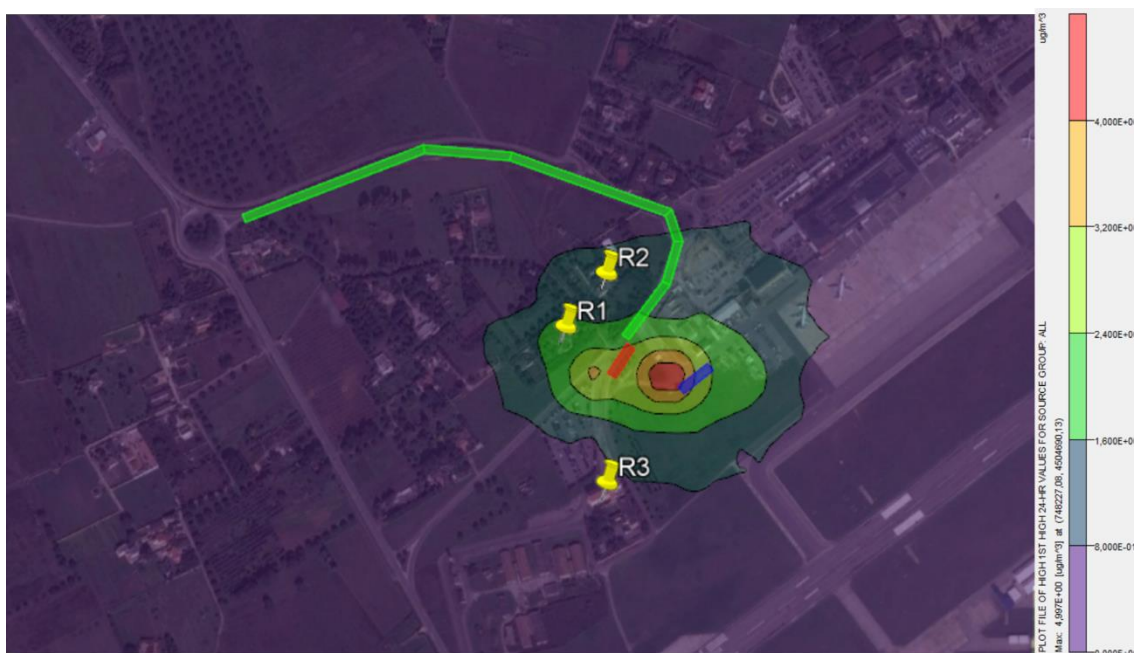
Figura 6-16 Curve di isoconcentrazione relative ai massimi giornalieri di PM10 sulla maglia di calcolo
