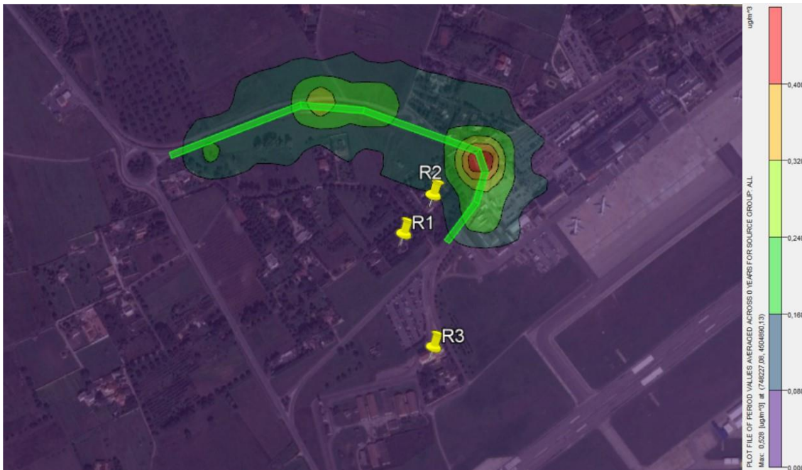
Figura 6-19 Curve di isoconcentrazione relative alle medie annue di NOx sulla maglia di calcolo
