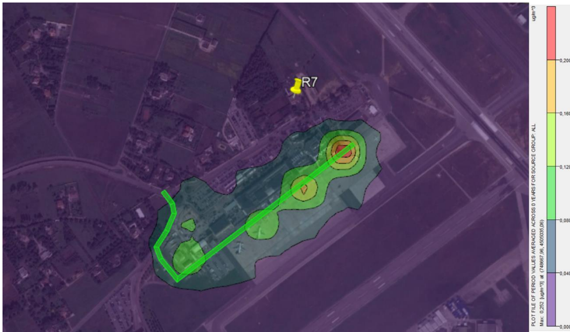
Figura 6-31 Curve di isoconcentrazione relative alle medie annue di NOx sulla maglia di calcolo
