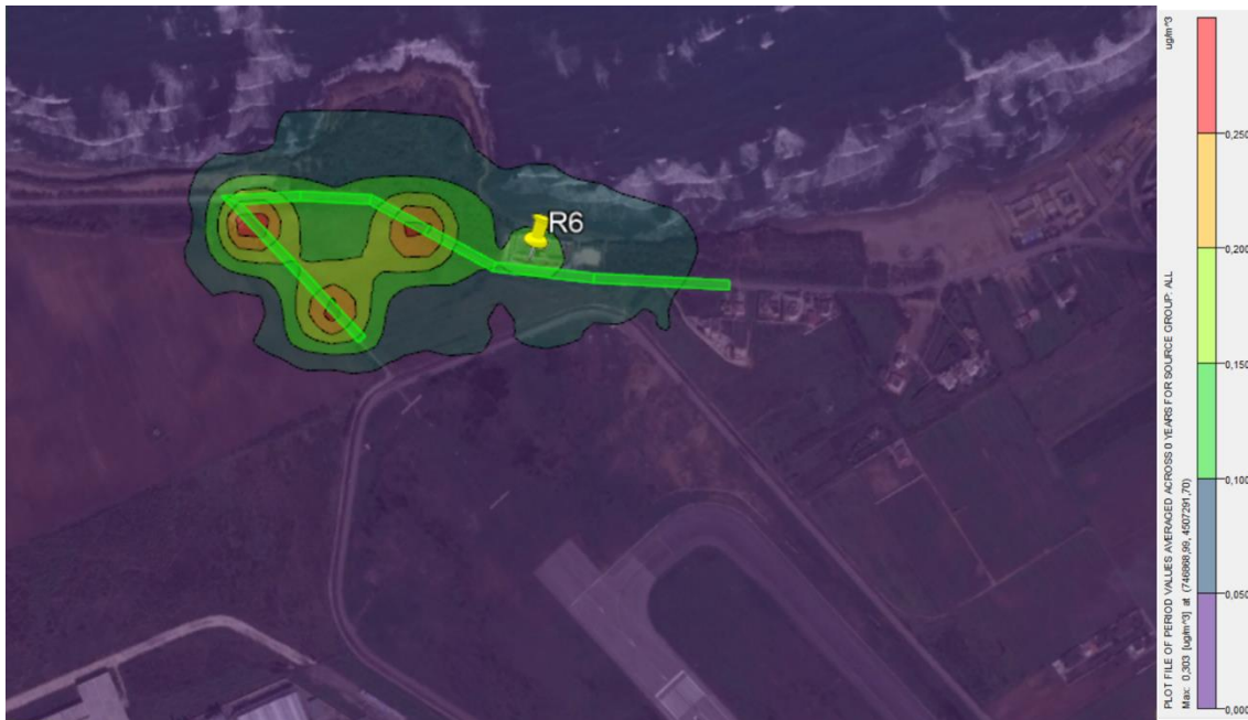
Figura 6-27 Curve di isoconcentrazione relative alle medie annue di NOx sulla maglia di calcolo
