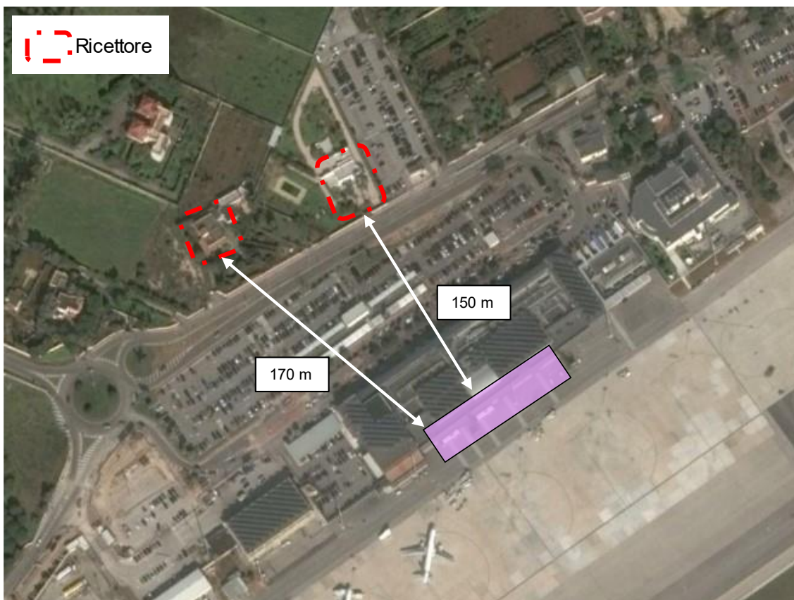
Figura 6-55 Localizzazione di ricettori rispetto le attività di scavo previste per la realizzazione per la realizzazione dell'ampliamento air-side dell'aerostazione
