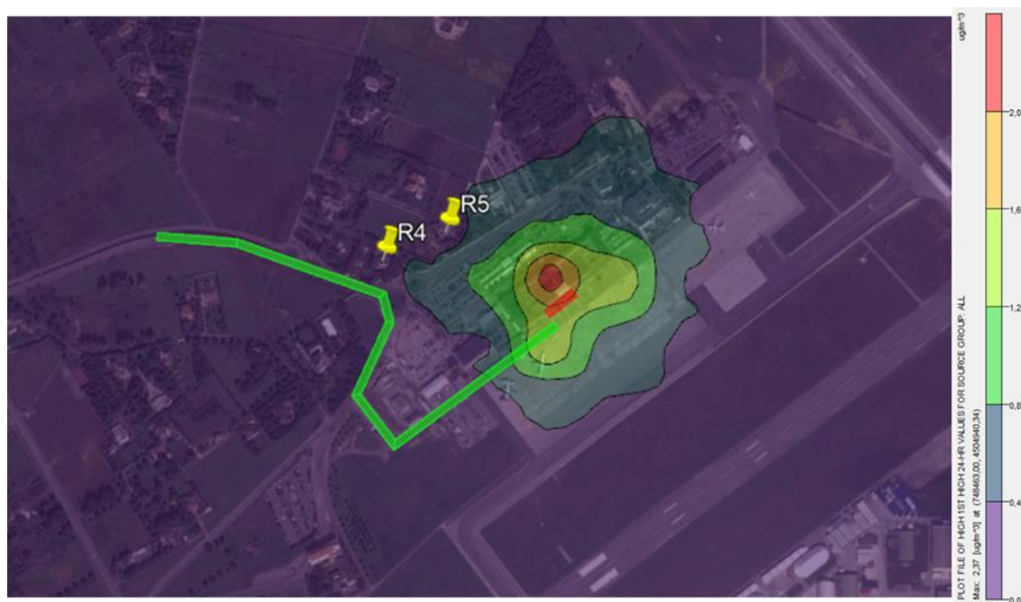
Figura 6-20 Curve di isoconcentrazione relative ai massimi giornalieri di PM10 sulla maglia di calcolo
