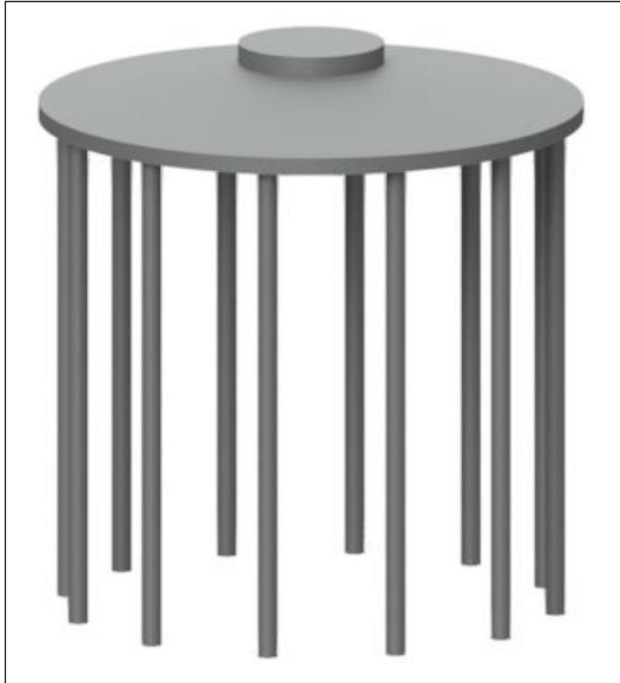
Figura 7: vista tridimensionale della fondazione dell'aerogeneratore
