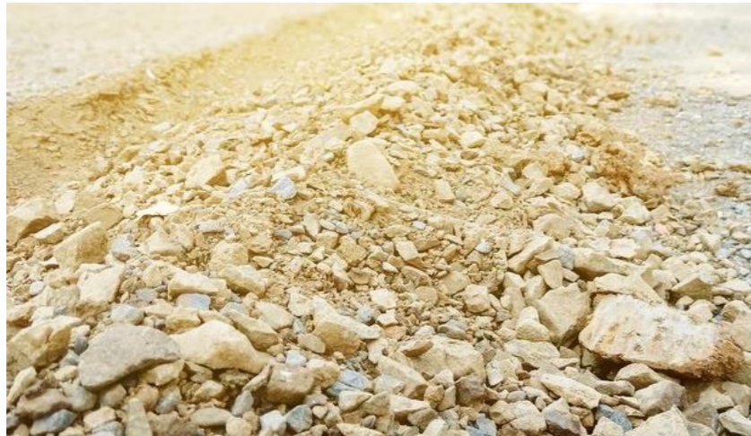
Figura 8 – Misto da cava per la realizzazione della viabilità e delle piazzole
