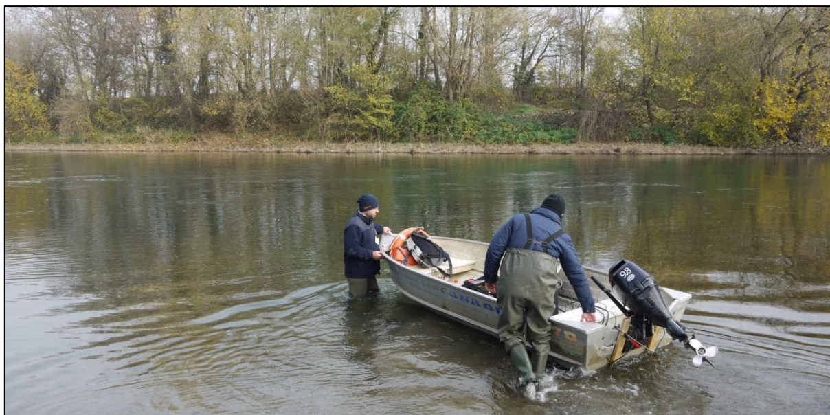
FIGURA 3 – ATTIVITÀ DI RILEVAMENTO CON ECOSCANDAGLIO DA IMBARCAZIONE
