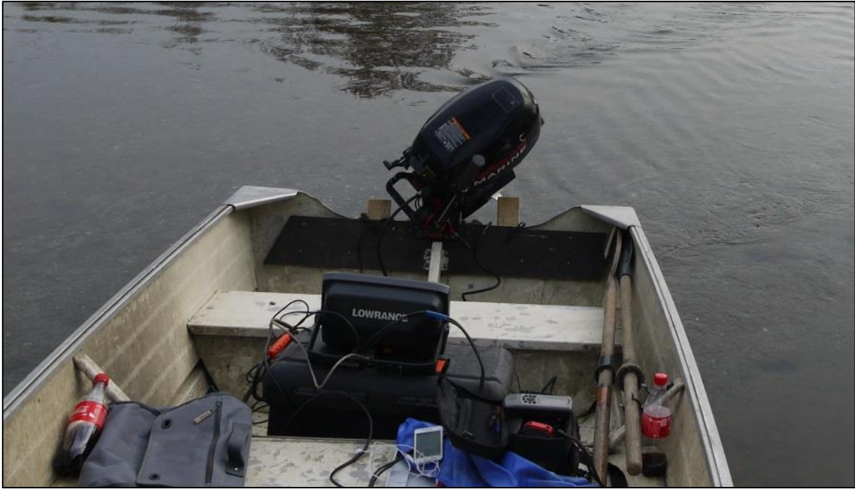
FIGURA 8 – ATTREZZATURA ED ATTIVITÀ CON ECOSCANDAGLIO DA IMBARCAZIONE
