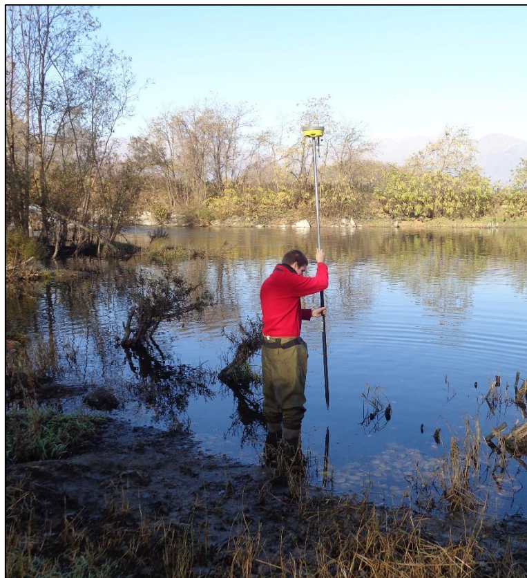
FIGURA 11 – RILIEVO A GUADO DELLE SPONDE CON SISTEMA GPS
