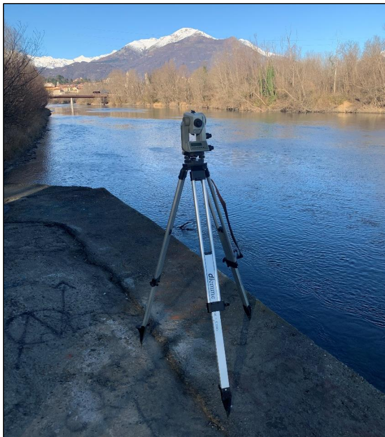
FIGURA 10 – ATTREZZATURA TOPOGRAFICA PER CONSENTIRE ALLINEAMENTO DEL RILIEVO TOPOGRAFICO (RILIEVO A GUADO CON ASTA GRADUATA E STAZIONE SU PILA PONTE SS26)
