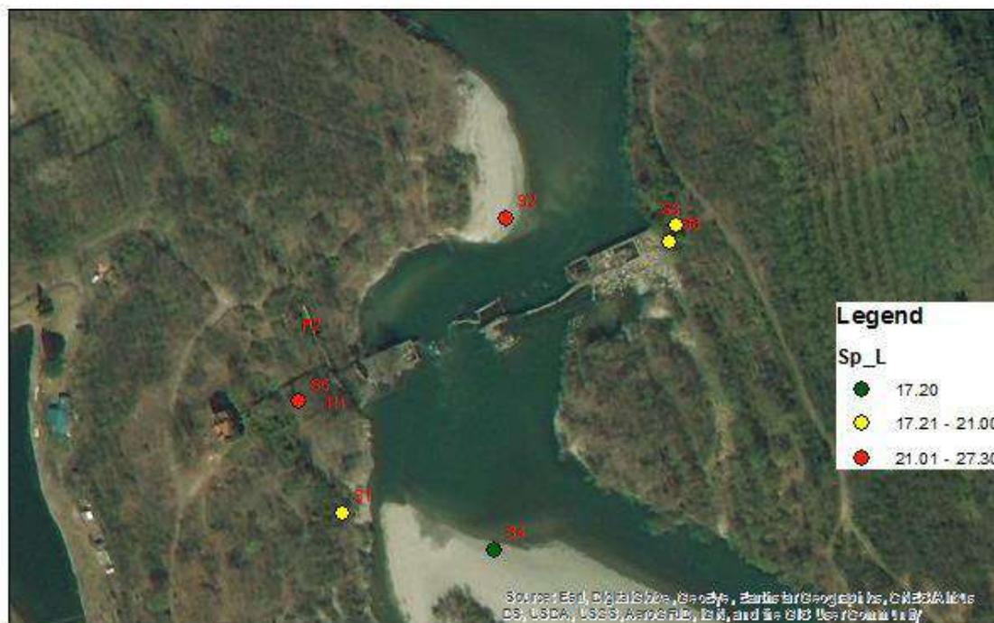
**Figura 38: Spessore rilevato dello strato limoso**
