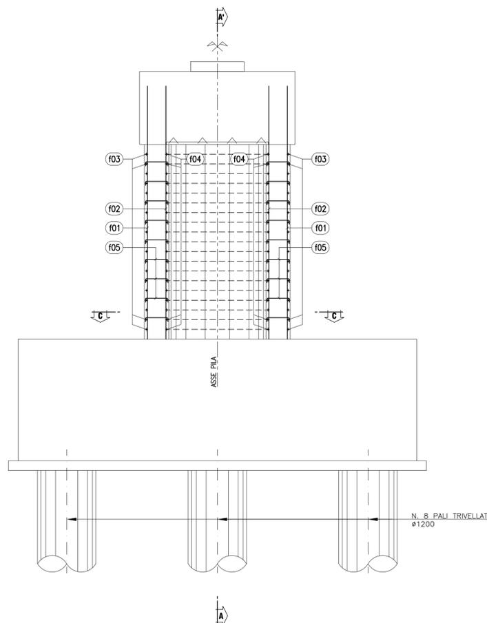
**PILA 2 - SEZIONE C-C'**
