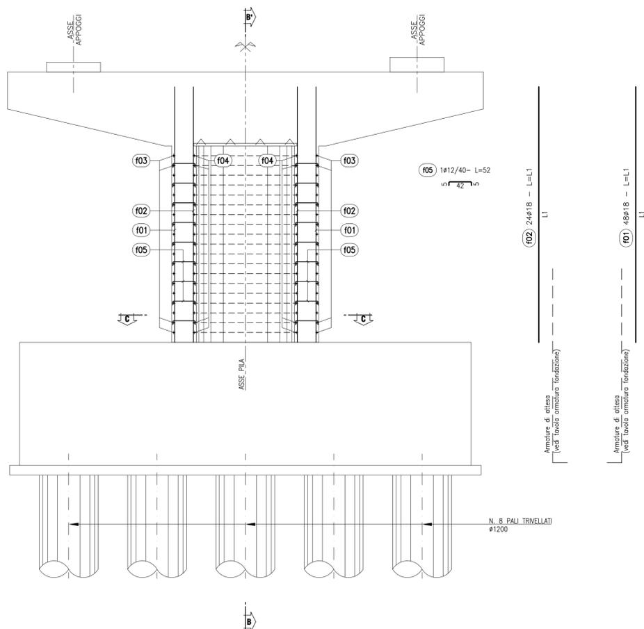
**PILA 2 - SEZIONE B-B'**
