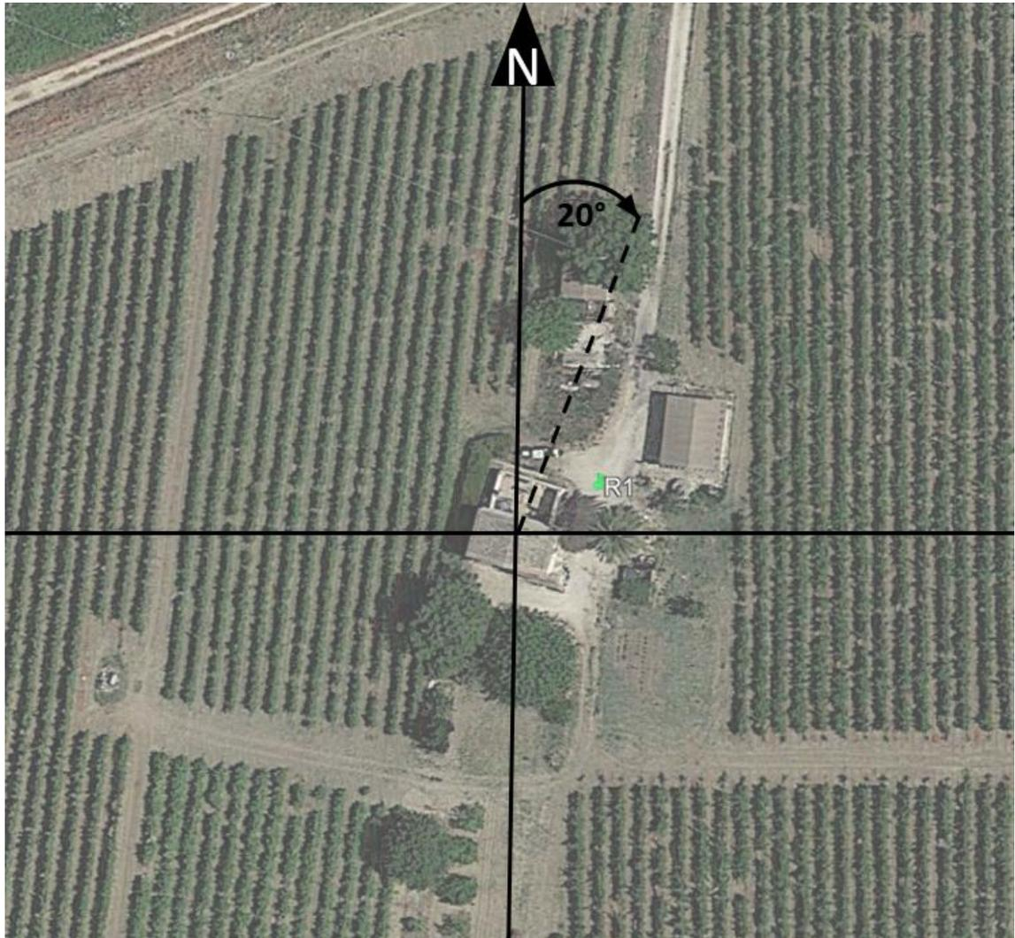
*Figura 3-2 Esempio di identificazione dell'orientamento delle finestre dei ricettori*
