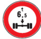
Figura I 69 Art. 118 TRANSITO VIETATO AI VEICOLI AVENTI MASSA PER ASSE SUPERIORE A ..... TONNELLATE
