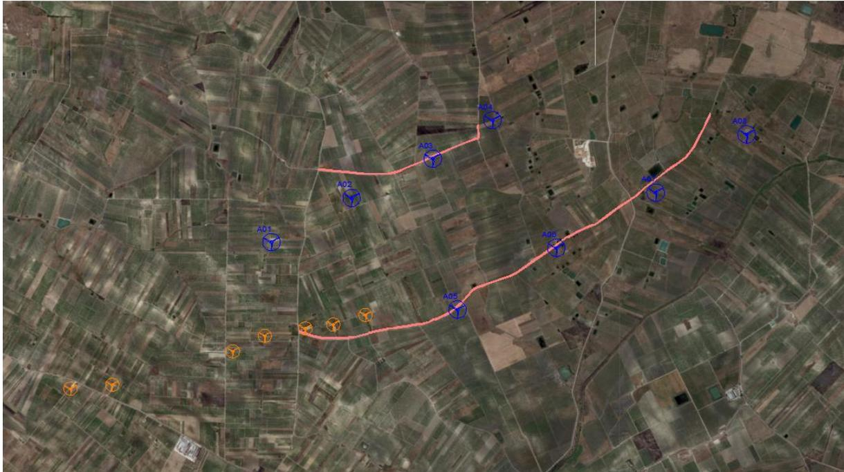
Figura 12 – Schema layout con indicazione delle torri esistenti nei pressi del sito d’installazione (in arancione) e degli assi viari esistenti che verranno adeguati per la realizzazione del campo eolico.
