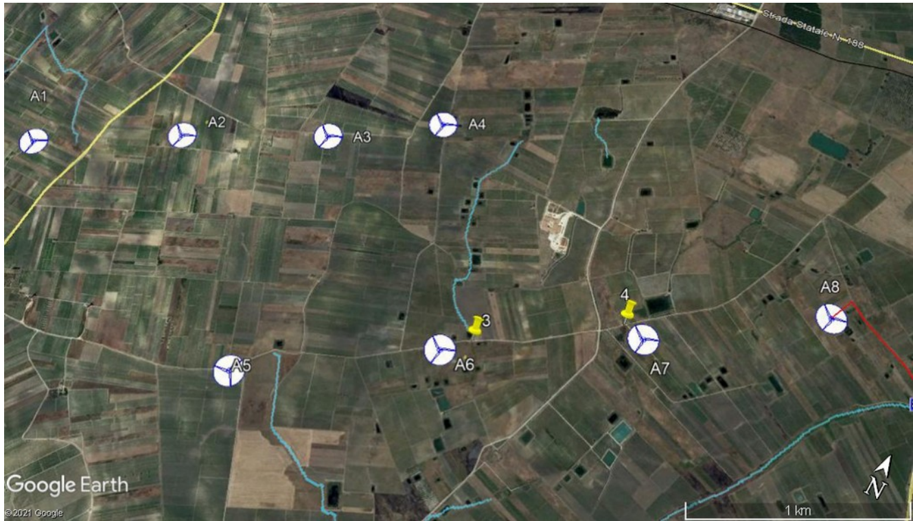
Interferenza della viabilità e del cavidotto con il reticolo idrografico nei punti 3 e 4
