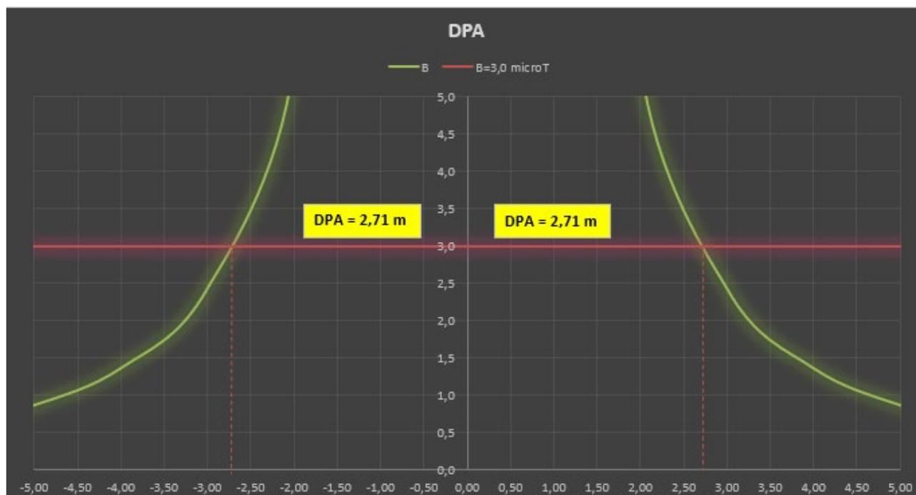
**Fig.16:** Andamento dell'induzione magnetica all'altezza dei conduttori per determinare la DPA
