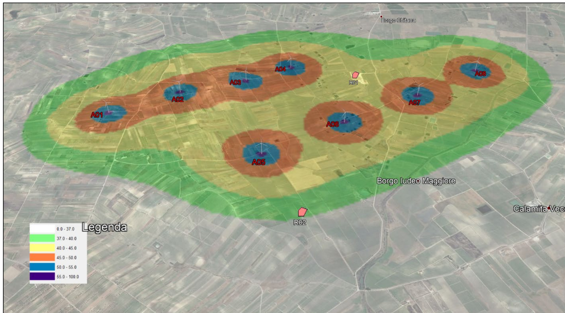
Figura 21: Mappa curve Isolivello del rumore emesso dagli aerogeneratori di progetto espresso in Leq(A) nelle condizioni di massima emissione elaborata per velocità del vento di 8 m/s in vista 3D estratta da Google Earth.
