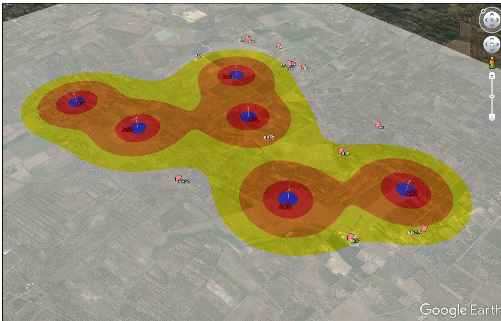
Figura 22: Mappa curve Isolivello del rumore Cumulativo emesso dagli aerogeneratori di progetto espresso in Leq(A) nelle condizioni di massima emissione elaborata per velocità del vento di 8 m/s su vista 3D estratta da Google Earth.
