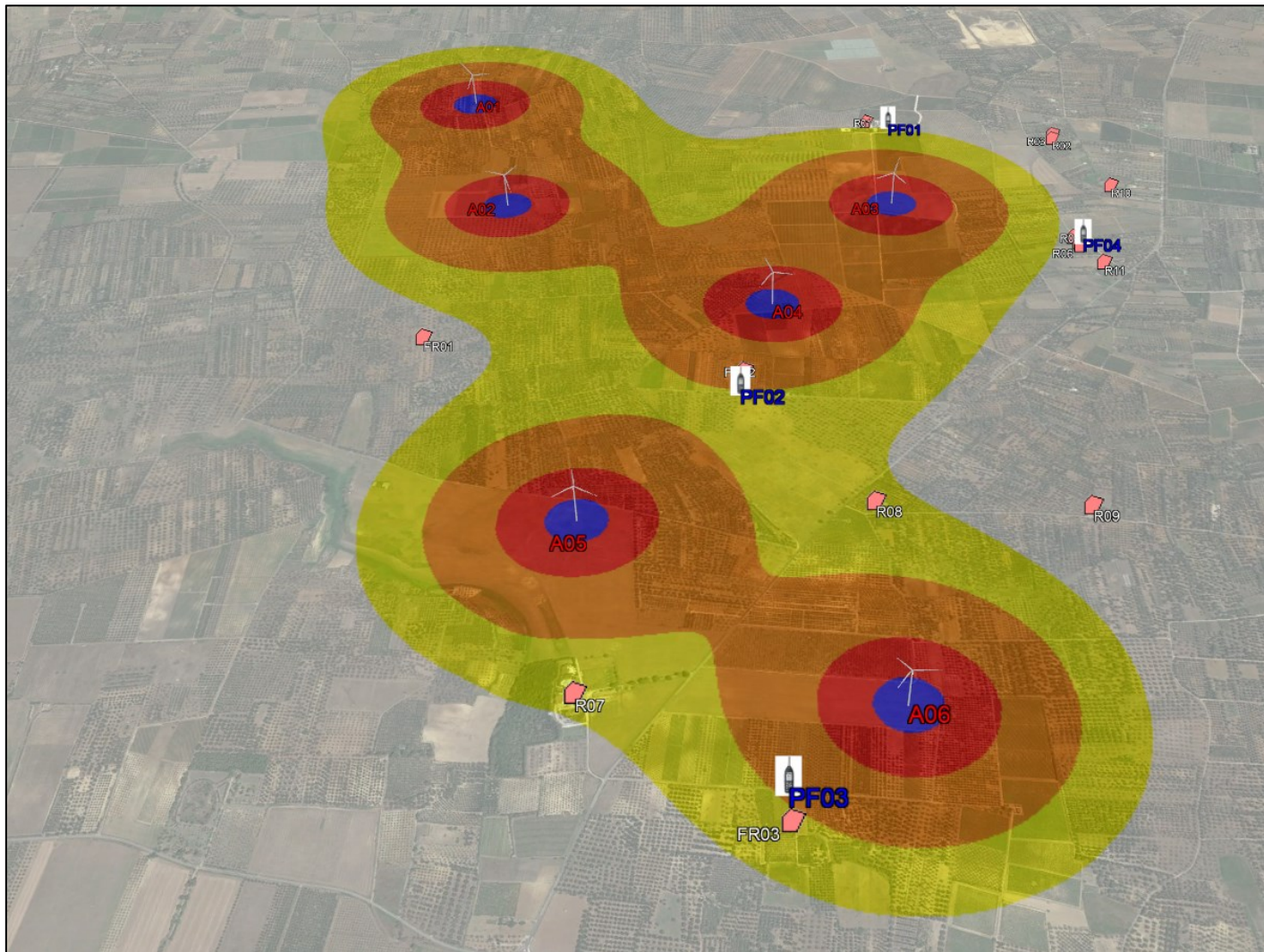
Figura 14: Individuazione delle postazioni fonometriche in relazione alle turbine di progetto ed ai recettori sensibili individuati su stralcio ortofotografico nella versione 3D.
