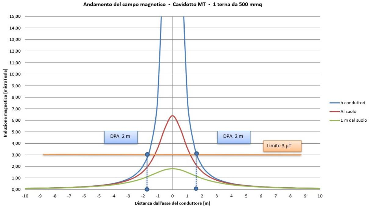
**Figura 4** Andamento del campo magnetico in funzione della distanza dall'asse dei conduttori in forma grafica relativa alla simulazione S4.
