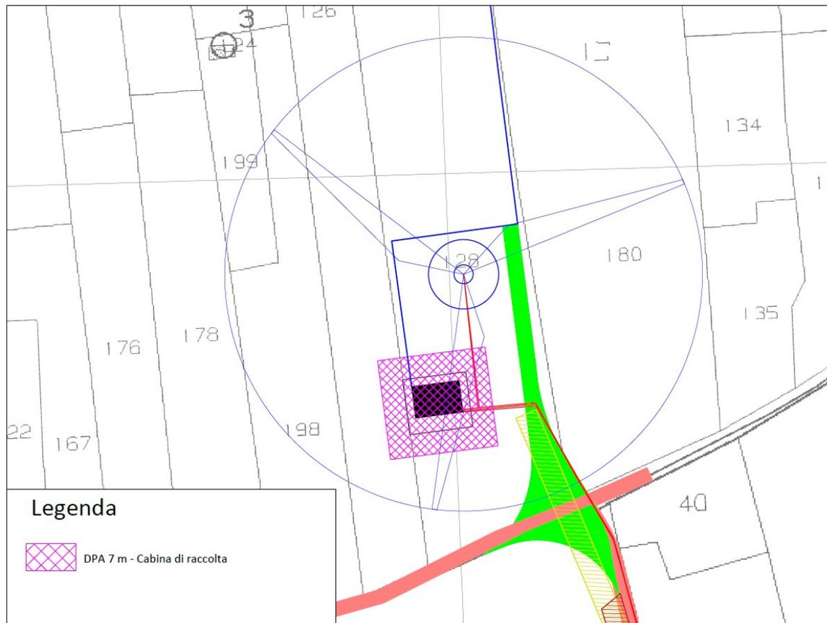
**Figura 13 Rappresentazione grafica della DPA cabina di raccolta impianto eolico.**
