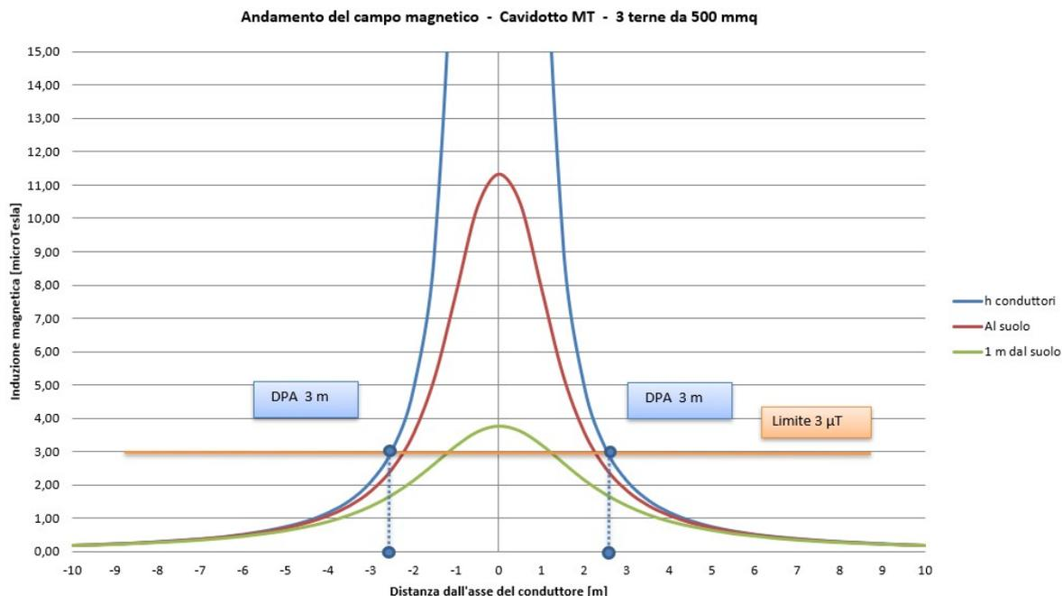
**Figura 5 Andamento del campo magnetico in funzione della distanza dall'asse dei conduttori in forma grafica relativa alla simulazione S5.**
