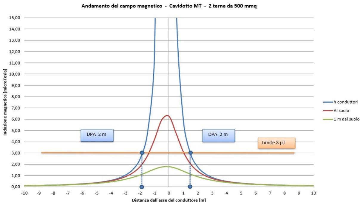
**Figura 3** Andamento del campo magnetico in funzione della distanza dall'asse dei conduttori in forma grafica relativa alla simulazione S3.
