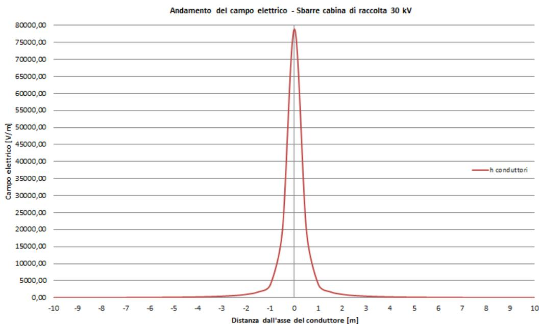
**Figura 12** Andamento del campo elettrico in funzione della distanza dall'asse dei conduttori in forma grafica – sbarre MT cabina di raccolta dell'impianto.
