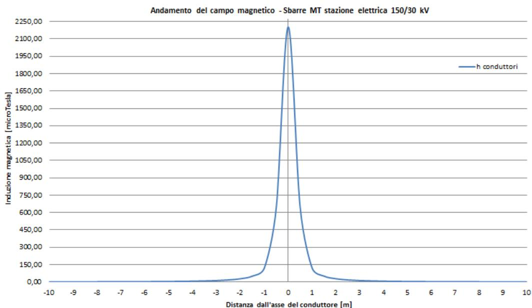
**Figura 11 Andamento del campo magnetico in funzione della distanza dall'asse dei conduttori in forma grafica – sbarre MT cabina di raccolta dell'impianto.**
