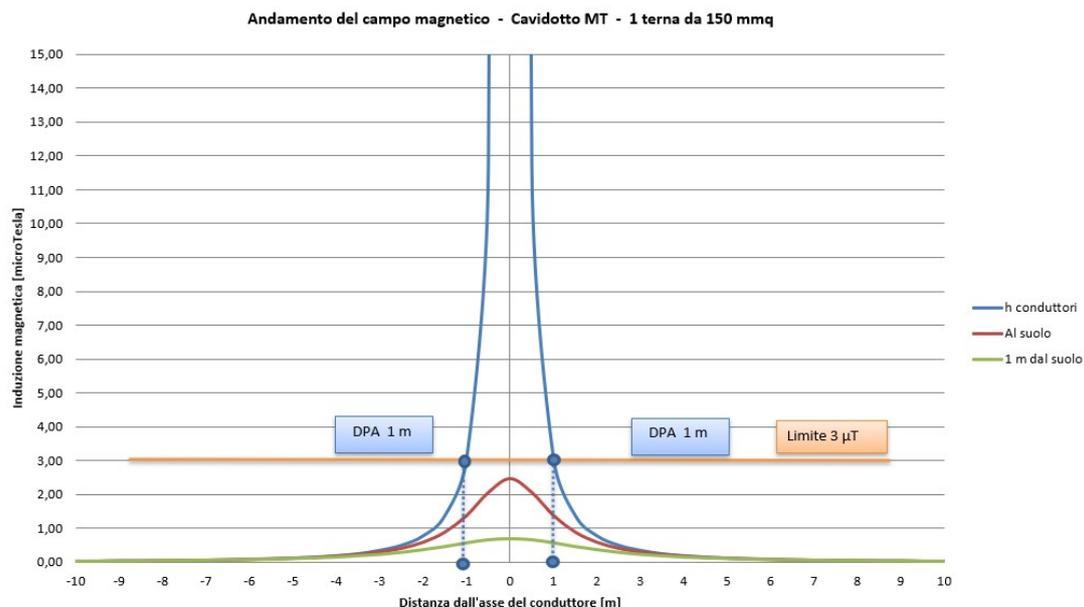
**Figura 1 Andamento del campo magnetico in funzione della distanza dall'asse dei conduttori in forma grafica relativa alla simulazione S1.**
