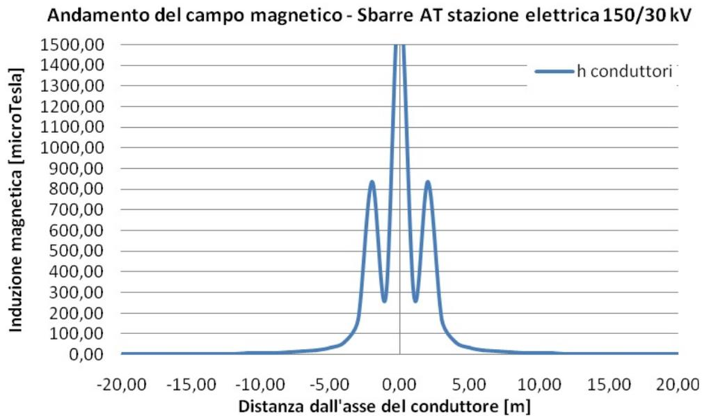
**Figura 14 Andamento del campo magnetico in funzione della distanza dall'asse dei conduttori in forma grafica - Sbarre AT stazione elettrica 30/150 kV - Valutazione della Distanza di prima Approssimazione.**
