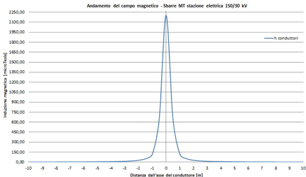
**Figura 15 Andamento del campo magnetico in funzione della distanza dall'asse dei conduttori in forma grafica - Sbarre MT stazione elettrica 30/150 kV - Valutazione della Distanza di prima Approssimazione.**
