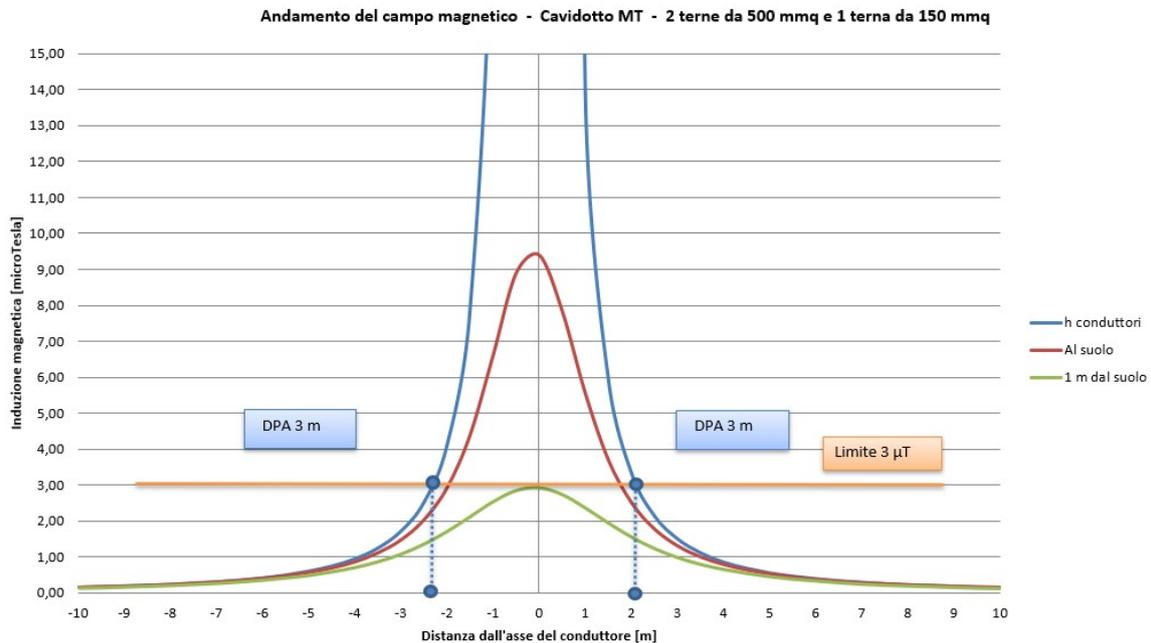
**Figura 2 Andamento del campo magnetico in funzione della distanza dall'asse dei conduttori in forma grafica relativa alla simulazione S2.**
