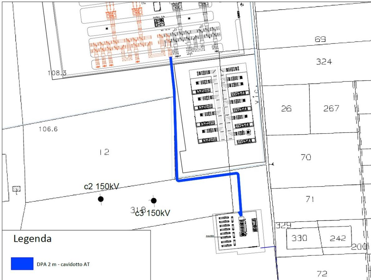
**Figura 20** Rappresentazione grafica delle DPA del cavidotto di collegamento AT alla stazione 150 kV.
