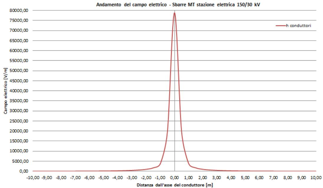
**Figura 17 Andamento del campo elettrico in forma grafica – edificio MT in stazione elettrica 30/150 kV.**
