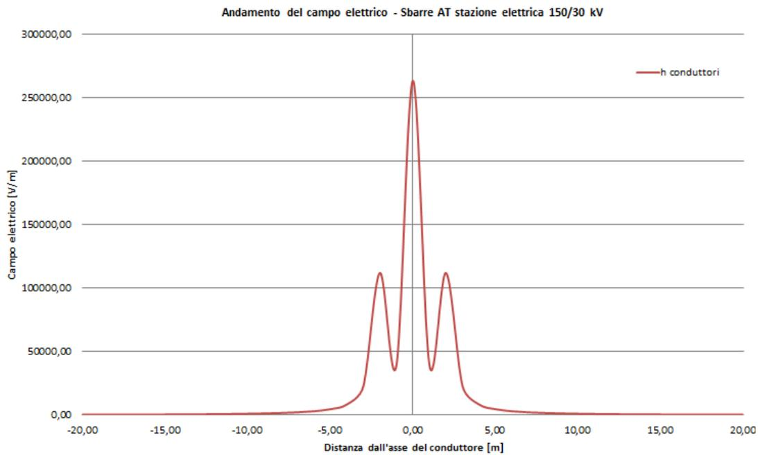
**Figura 16 Andamento del campo elettrico in forma grafica - Sbarre AT stazione elettrica 30/150 kV.**
