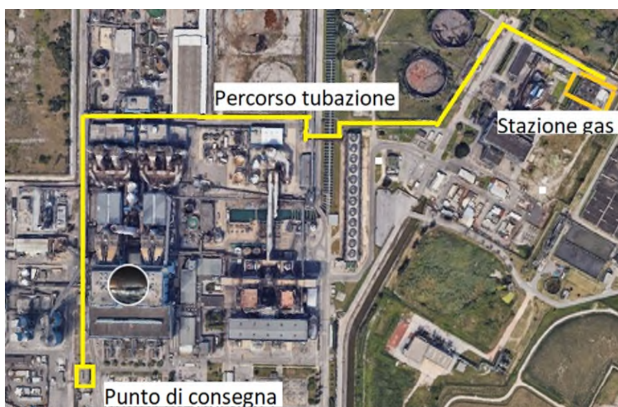
Figura – Prima soluzione collegamento PDR esistente
