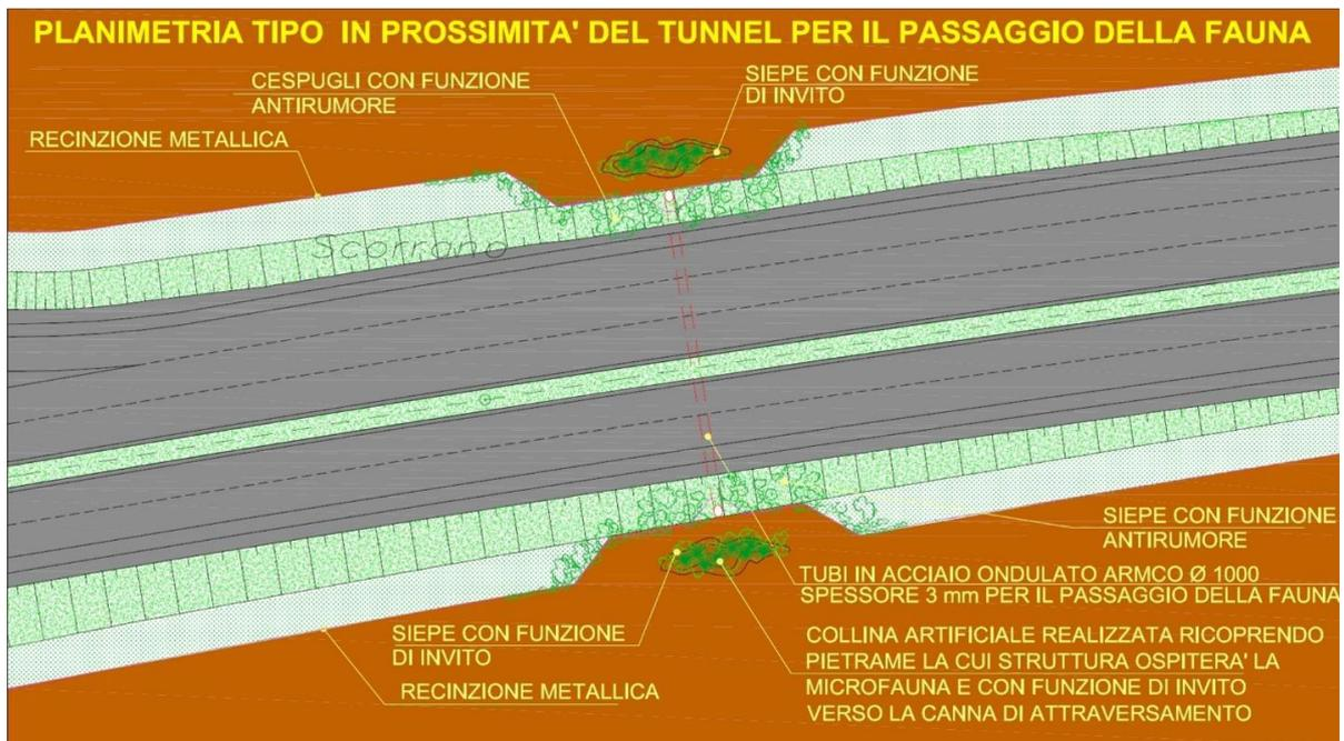
Fig. 6: Schema di tunnel faunistico – pianta esterno
