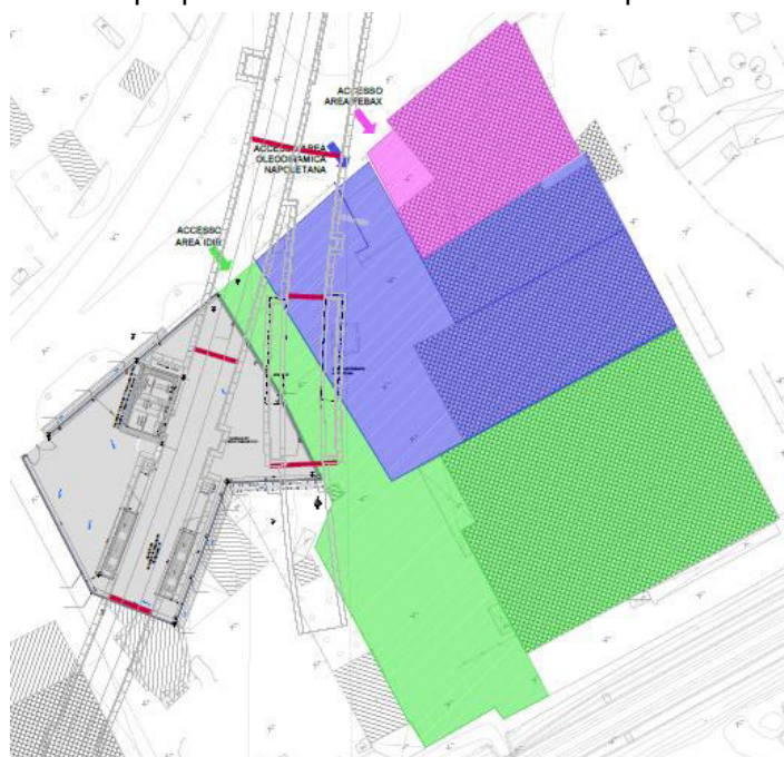
Planimetria piazzale Uscita STI - Progetto di Variante - Con i colori verde e blu si individuano rispettivamente le proprietà e gli accessi delle ditte rispettivamente IDIR e Oleodinamica Napoletana ripristinati a seguito del progetto di variante
