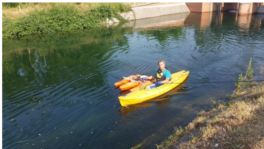
Figura 4.8: Misura della portata sul Canale Villoresi con ADCP (battellino) sulla sezione a valle della
