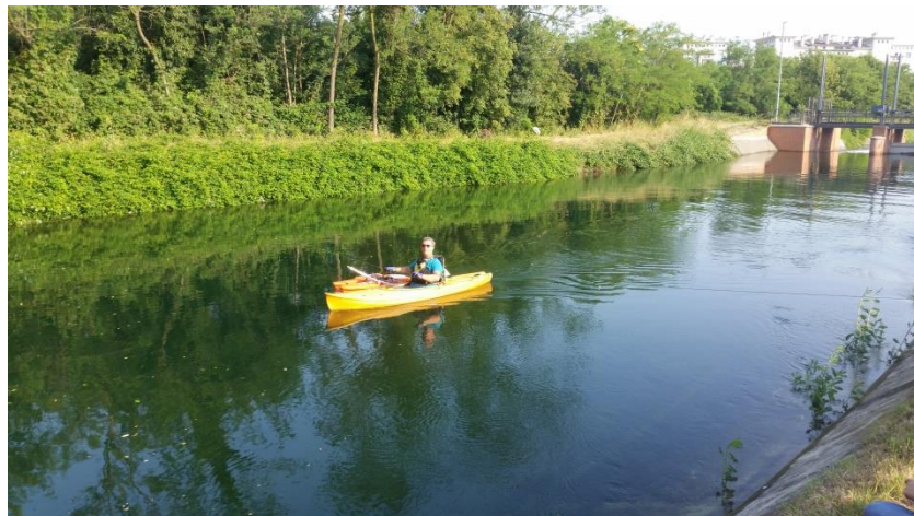
Figura 4.7: Misura della portata sul Canale Villoresi con ADCP (battellino) sulla sezione a monte della derivazione del Derivatore Parabiago.
