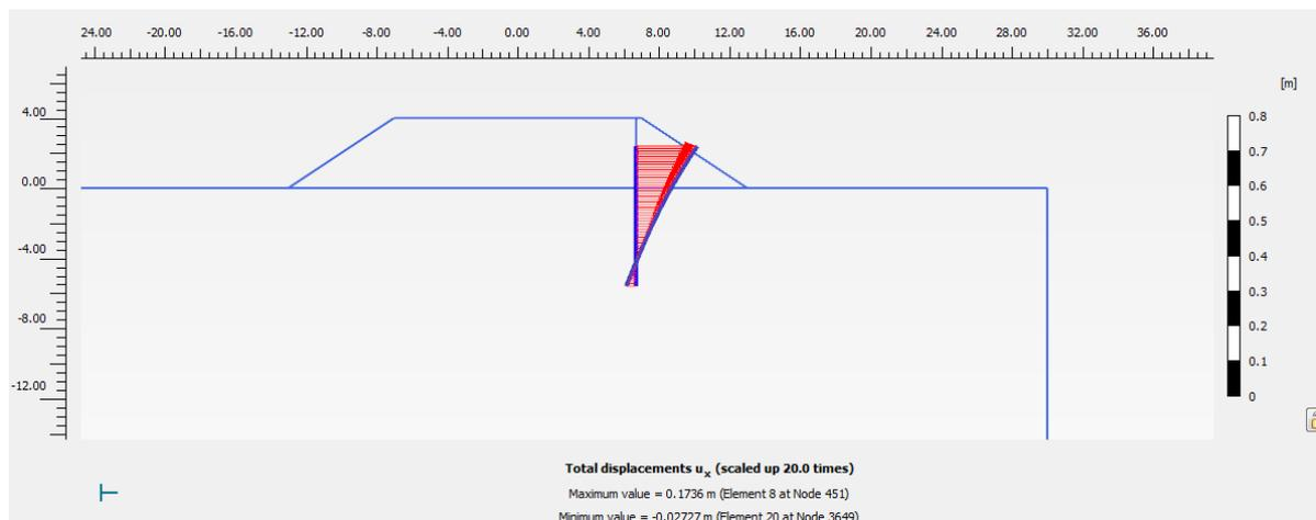
**Figura 4 Sezione tipo di recinzione su rilevato di altezza media. Spostamenti palo**
