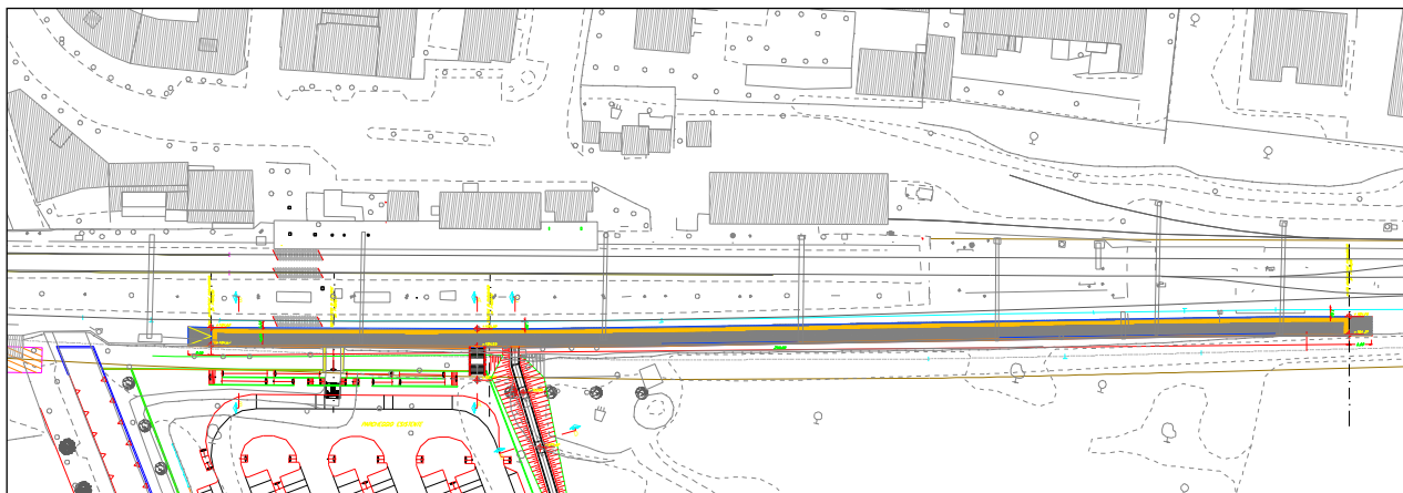
Inquadramento del marciapiede provvisorio esterno al 3° binario della fermata di parabiago
