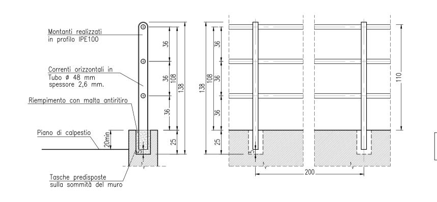
Ringhiera in acciaio classe S275J0 o superiore secondo norma UNI EN 10025-2005, zincato a caldo secondo normativa UNI EN 1461
