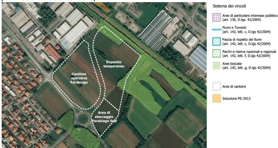
Figura 13 – Deposito temporaneo Parabiago (DT01) interferenza marginale con area boscata (evitabile in fase di perimetrazione del cantiere)
