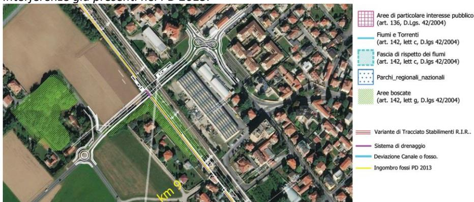
Figura 39 – Interferenza fosso drenante con una fascia boscata in corrispondenza del nuovo sottovia “Via Resegone” (Comune di Parabiago) – interferenza già presente nel PD 2013
