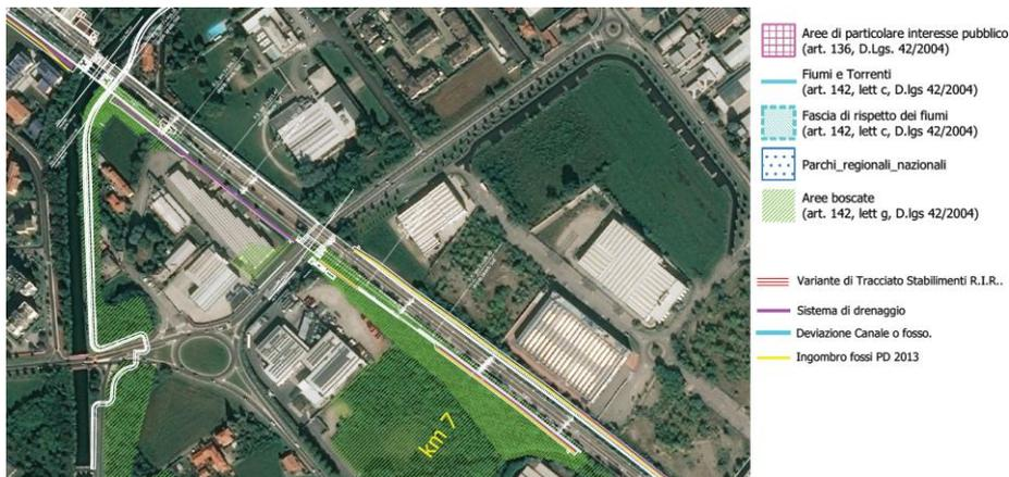
Figura 9 – Interferenze dei fossi drenanti con le fasce boscate a ridosso dell’infrastruttura (Comune di Parabiago) – Interferenze già presenti nel PD 2013.
