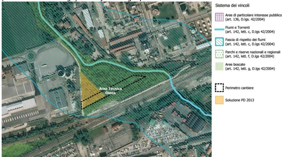
Figura 10 –Area tecnica Olona (AT01) interferenza con la fascia di rispetto del Fiume Olona e con un’area boscata - interferenza già presente nel PD 2013
