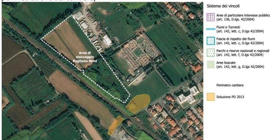
Figura 12 – Area di stoccaggio Pogliano nord (AS02) interferenza marginale con un'area boscata (evitabile in fase di perimetrazione del cantiere)
