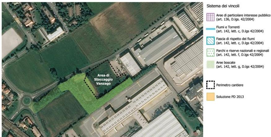
Figura 11 – Area di Stoccaggio Vanzago (AS01) interferenza marginale con un'area boscata (evitabile in fase di perimetrazione del cantiere)
