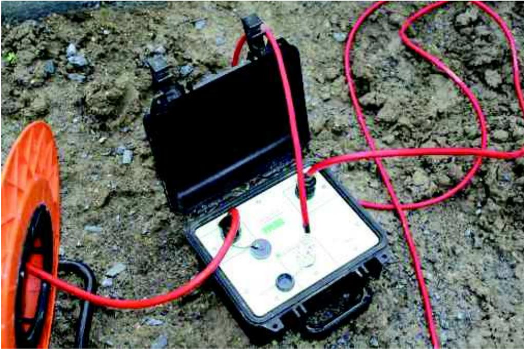
Fig. 10 Link box, componente di collegamento tra due gruppi di elettrodi
