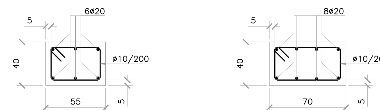
SEZIONI TIPOLOGICHE ARMATURA: SCALA 1:20
