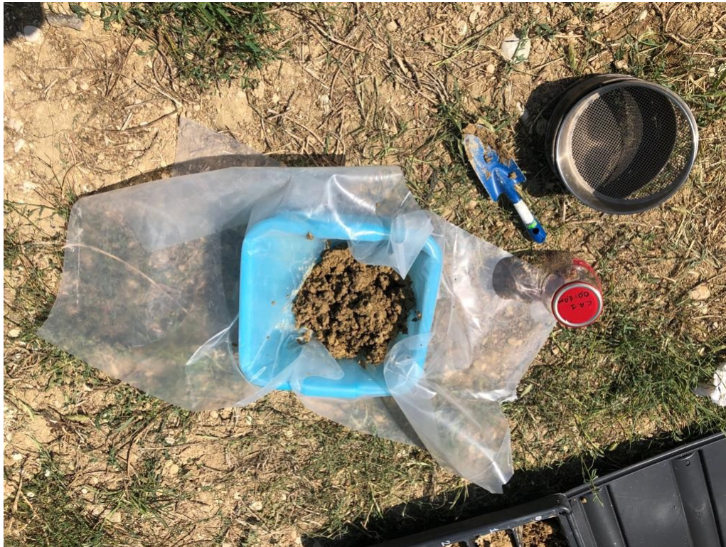
Fig. 2 – Setacciatura del terreno da campionare
