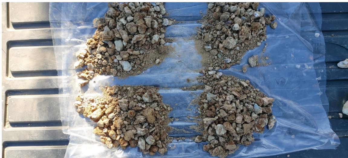
Fig. 3 –Quartatura del terreno da campionare
