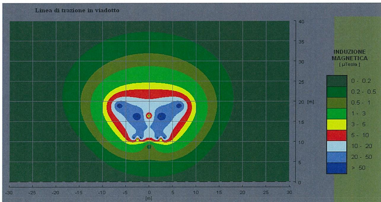
Fig. 2 – Campo magnetico della linea di trazione tipologia in viadotto
