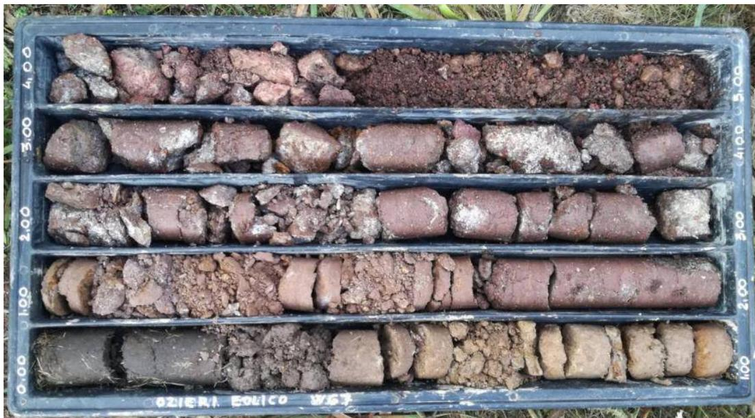
*Figura 11: Sondaggio WG7: da 0,00 m a 5,00 m.*
