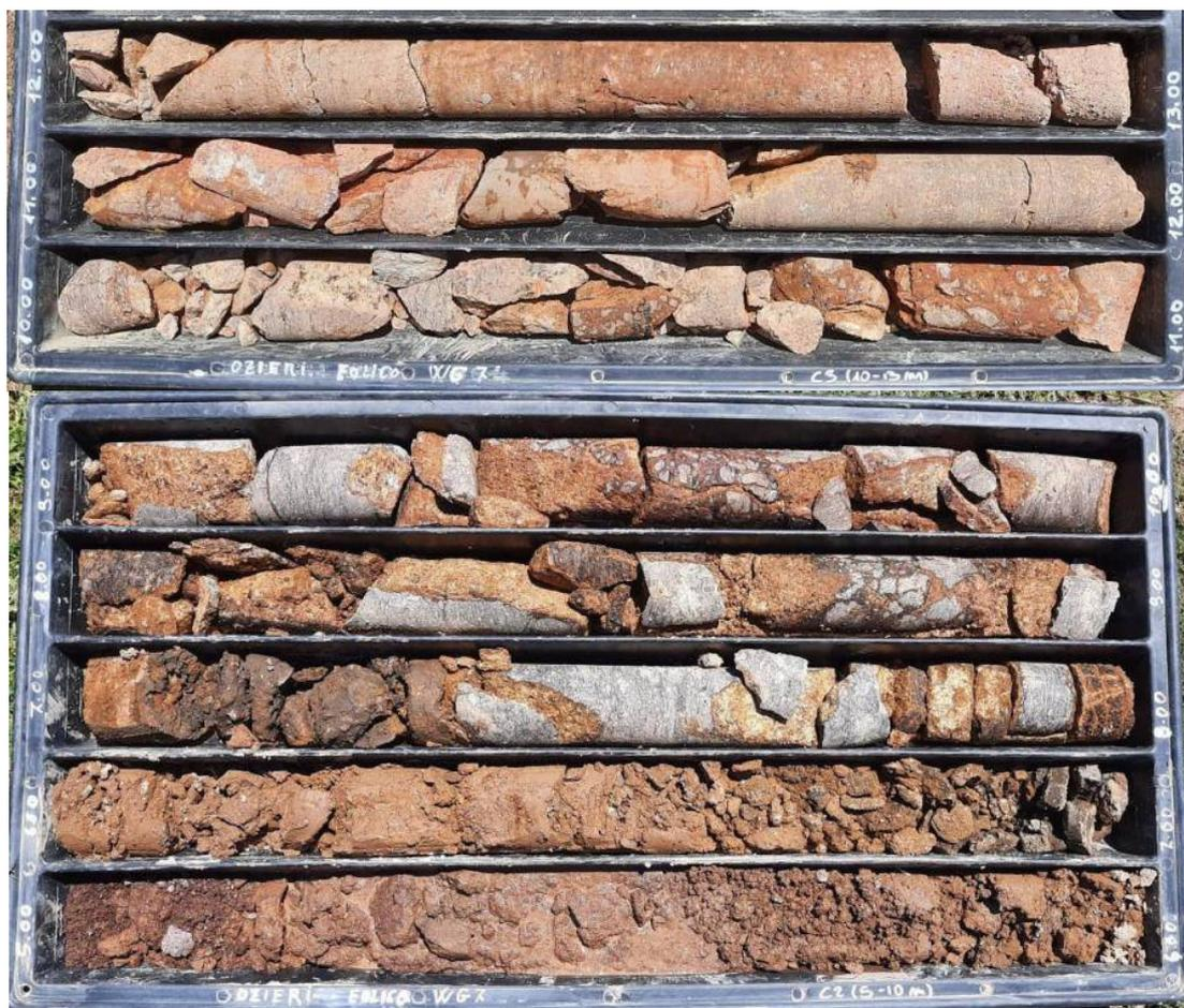
*Figura 12: Sondaggio WG7: da 5,00 m a 13,00 m.*
