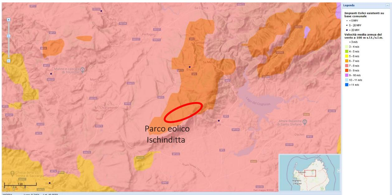
Figura 5 - Tavola 1 Velocità media annua dall'Atlante Eolico Interattivo <http://atlanteolico.rse-web.it/viewer.htm>
