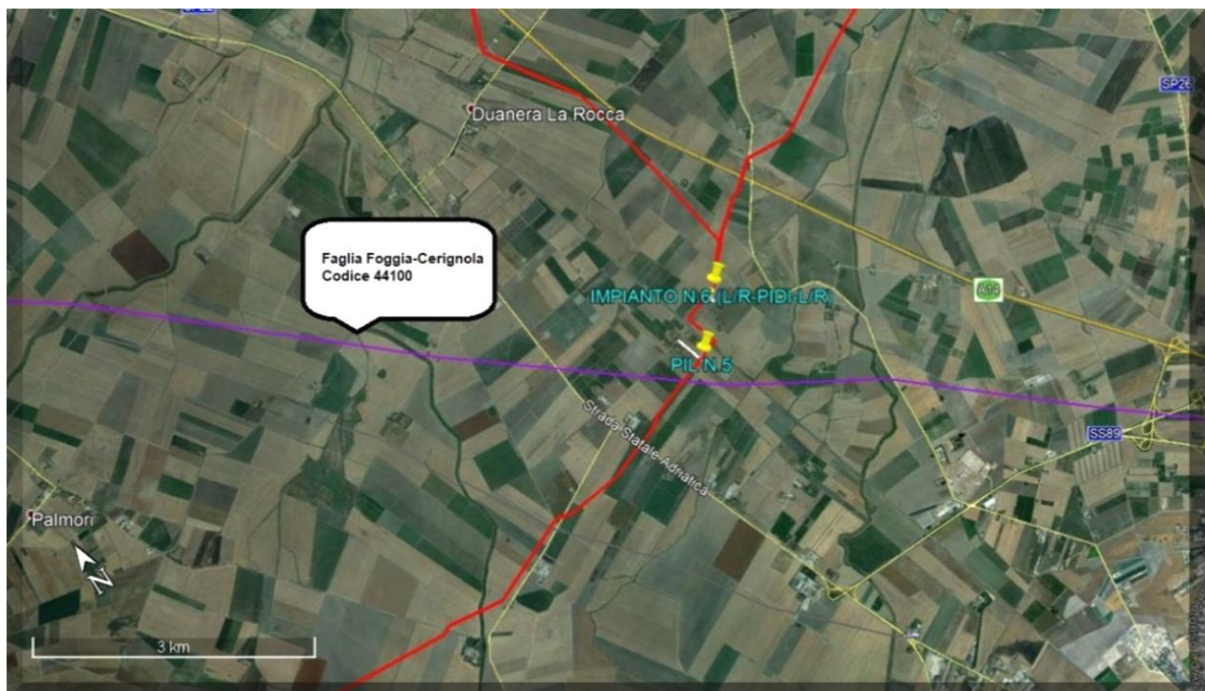
Figura 2-28 – Stralcio con ubicazione faglie attive e capaci estrapolato dal portale. Traccia faglia riportata in viola, interferente con il tracciato del gasdotto in progetto: Tratto Lucera - Foggia (Tratto 1)
