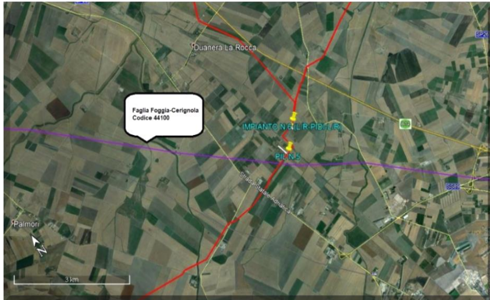
Figura 3-6 - Stralcio con ubicazione faglie attive e capaci estrapolato dal portale. Traccia faglia riportata in viola, interferente con il tracciato del metanodotto in progetto: Tratto Lucera - Foggia (Tratto 1)
