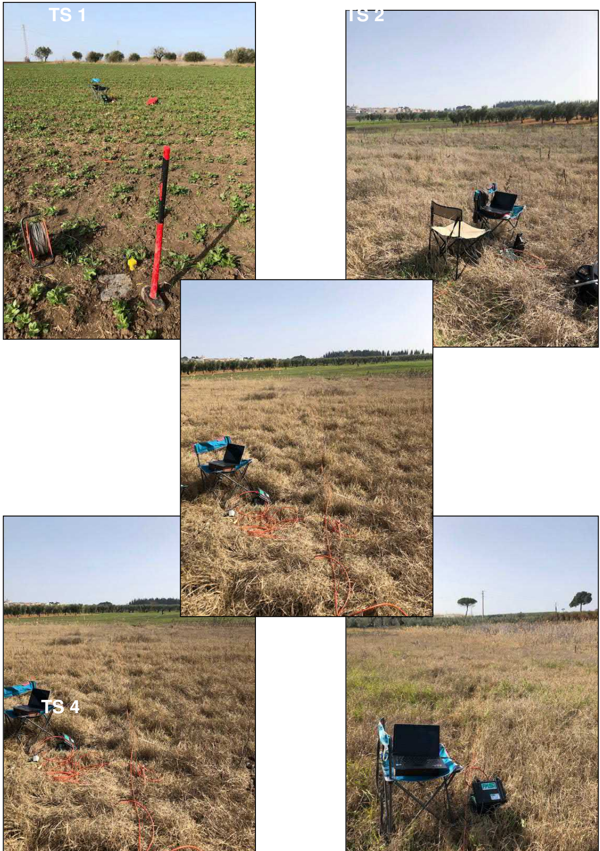
Foto 1 – Esecuzione del profilo sismico e della MASW n° 1
