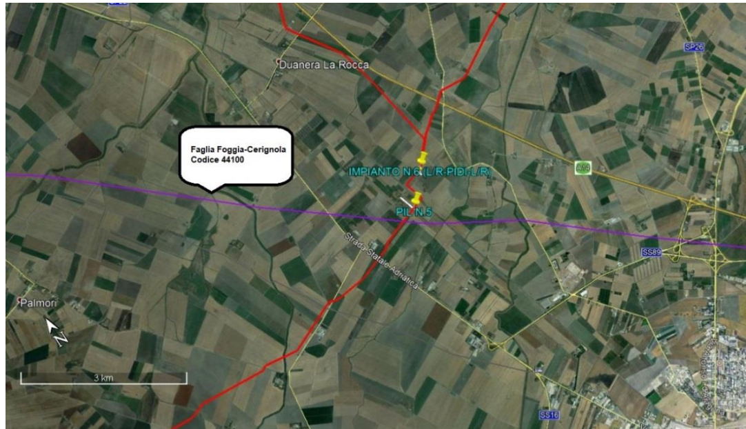
Figura 2.3.A – Stralcio con ubicazione faglie attive e capaci estrapolato dal portale http://sqi2.isprambiente.it/ithacaweb/viewer/index.html dell'I.S.P.R.A.. Traccia faglia riportata in viola, interferente con il tracciato del metanodotto in progetto: Tratto Lucera-Foggia (Tratto 1)
