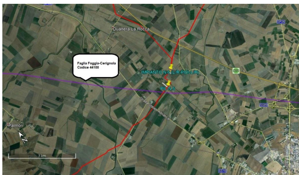
Figura 2.1.1 - Stralcio con ubicazione faglie attive e capaci estrapolato dal portale “ITHACA “ITaly Hazard from CApable faults”. Traccia faglia riportata in viola, interferente con il tracciato del metanodotto in progetto: Tratto Lucera-Foggia (Tratto 1)
