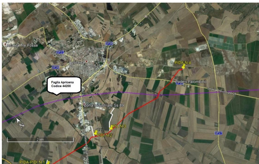
Figura 2.1.1 – Stralcio con ubicazione faglie attive e capaci estrapolato dal portale “ITHACA “ITaly HAZard from CApable faults”. Traccia faglia riportata in viola, interferente con il tracciato del metanodotto in progetto: Bretella 3 in comune di Apricena.
