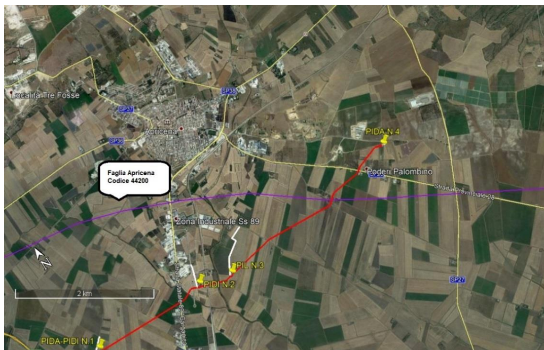
Figura 3.1.B – Stralcio con ubicazione faglie attive e capaci estrapolato dal portale http://sqi2.isprambiente.it/ithacaweb/viewer/index.html dell'I.S.P.R.A.. Traccia faglia riportata in viola, interferente con il tracciato del metanodotto in progetto: Bretella 3 in Comune di Apricena.
