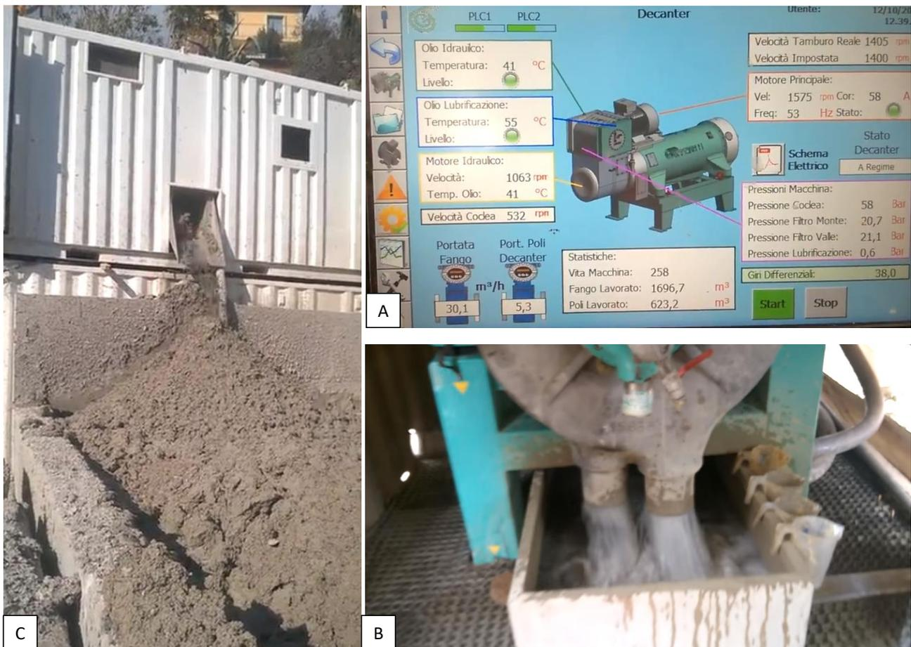
**Figura 5.14: impianto di ispessimento in funzione: A: controllo o computerizzato; B scarico acque; C scarico fanghi.**
