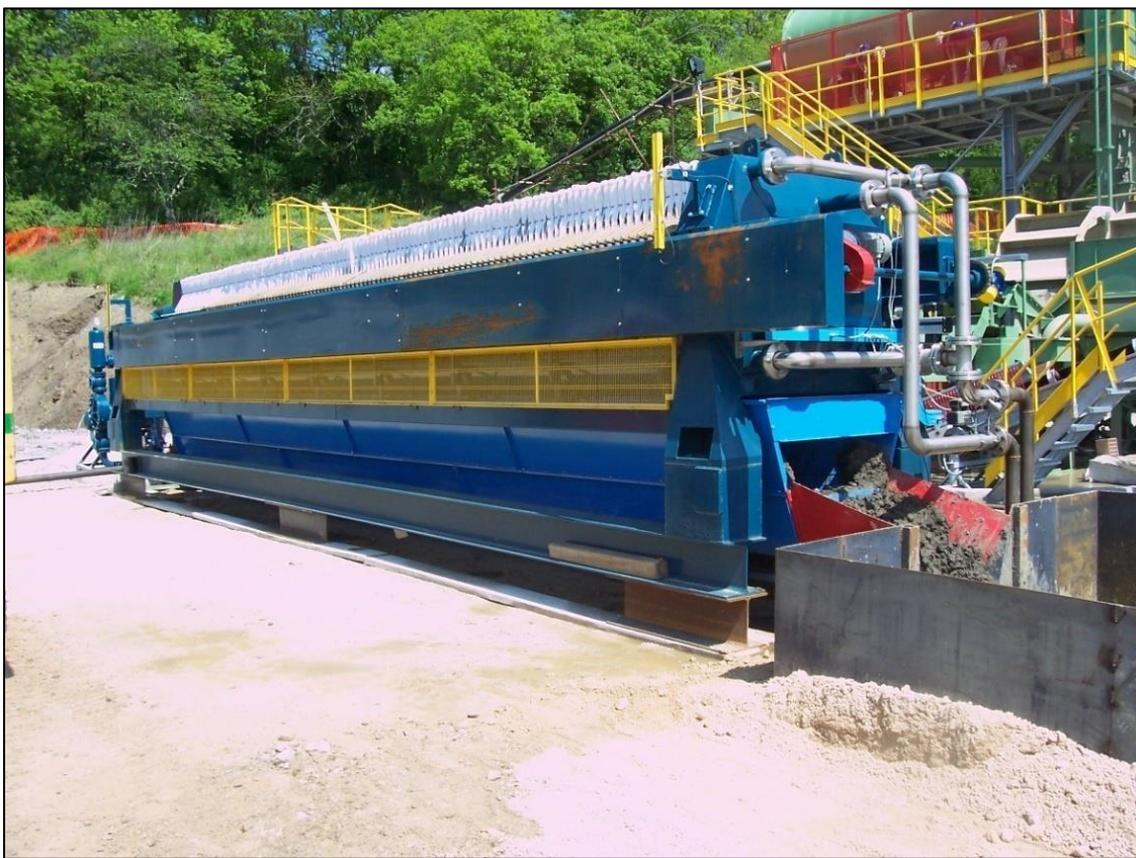
**Figura 3-18: esempio di filtropressa**
