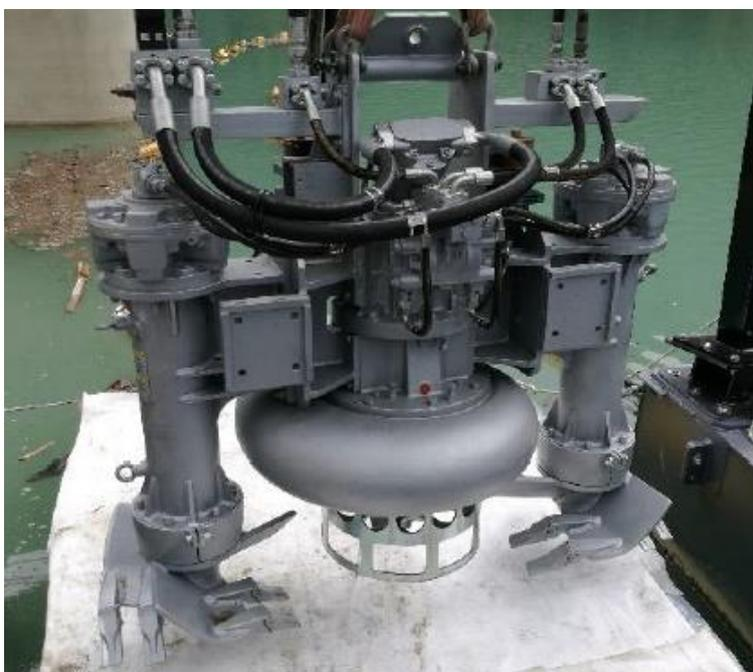
**Figura 3-12: esempio di pompa idraulica sommergibile**
