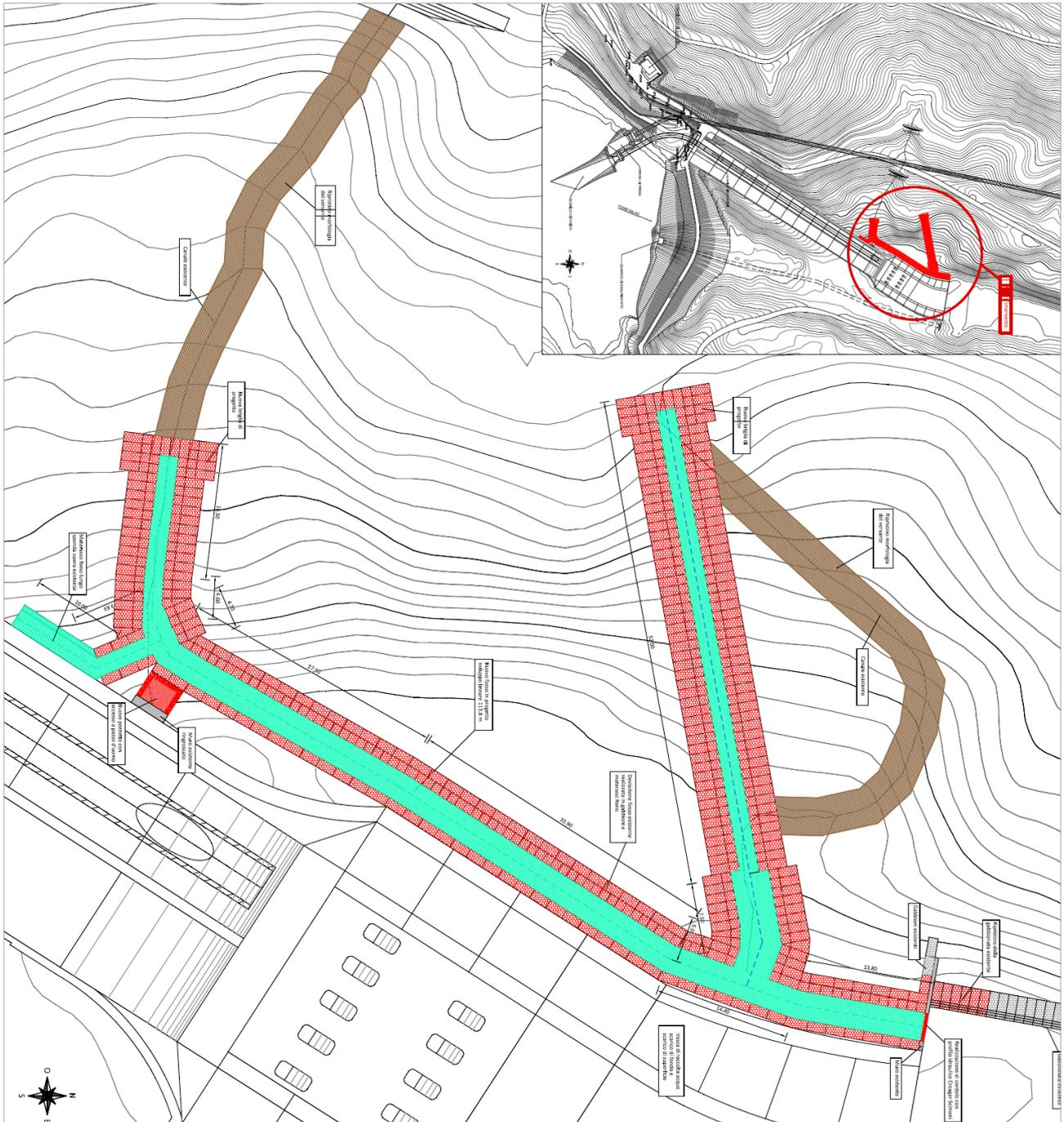
**Figura 2-46. Planimetria generale degli interventi in corrispondenza dell'area del dissesto estratto dall'elaborato "Opere di regimentazione idraulica\_Planimetria e ubicazione degli interventi"**
