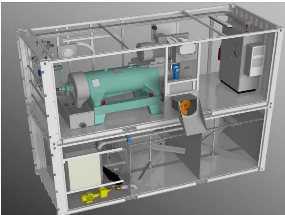
**Figura 2-44. Esempio di sistema integrato con centrifuga**
