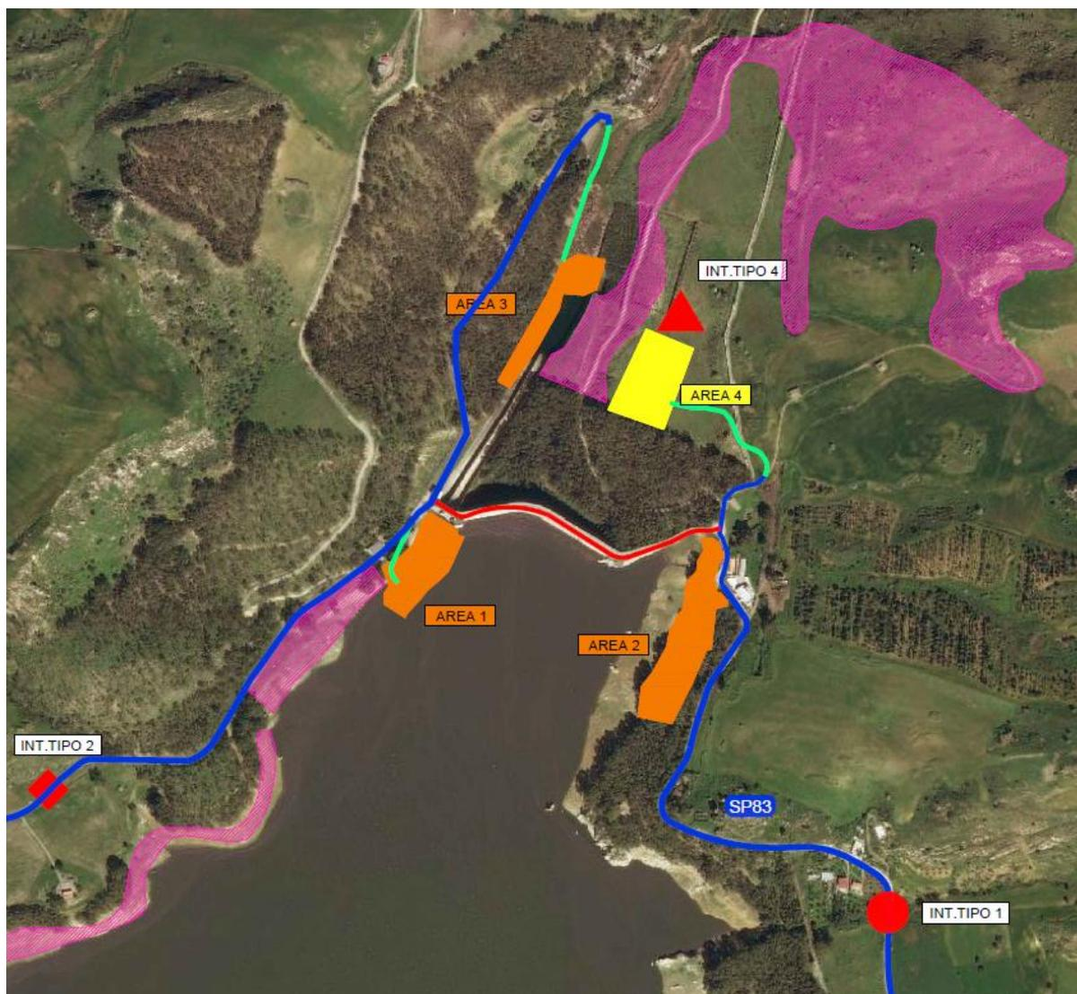
Figura 4-3. Localizzazione delle aree di cantiere estratta dall'elaborato "Percorsi di cantiere e ubicazione dei siti di cava e di deposito"
