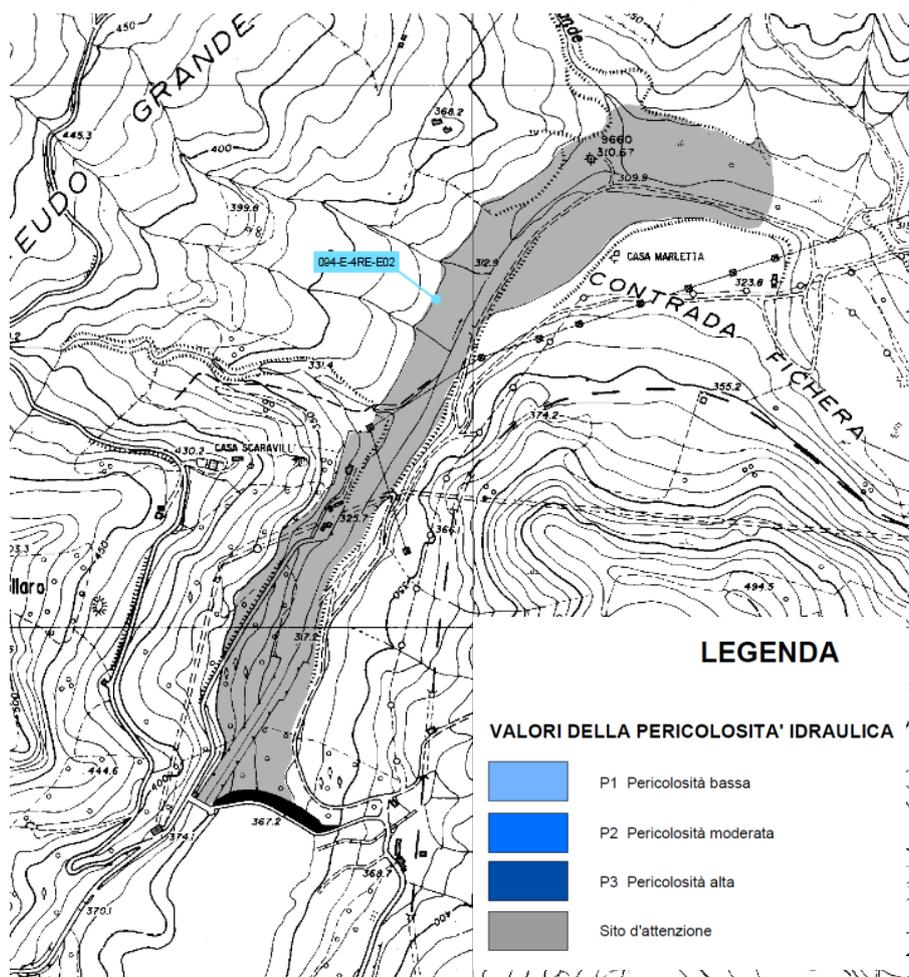
Figura 2-16. Estratto Carta della Pericolosità idraulica per fenomeni di esondazione n°50 (P. A. I.)
