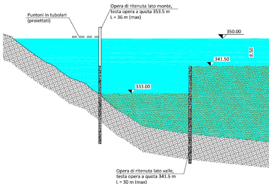
Figura 2-36. Rimozione dei sedimenti estratti dall'elaborato "Opere di difesa e dragaggio: Fasi di realizzazione"
