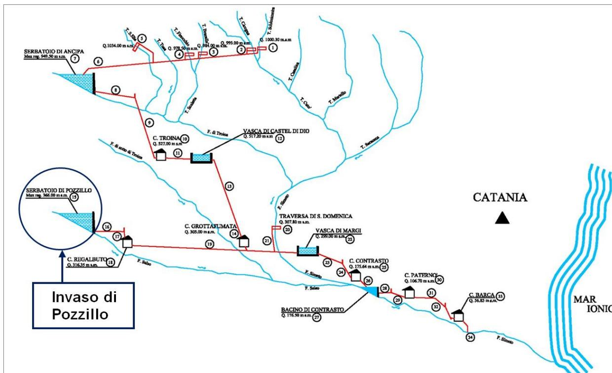
Figura 2-26. Invaso di Pozzillo e schema del sistema idraulico per l'utilizzazione del bacino idrografico del Salso-Simeto
