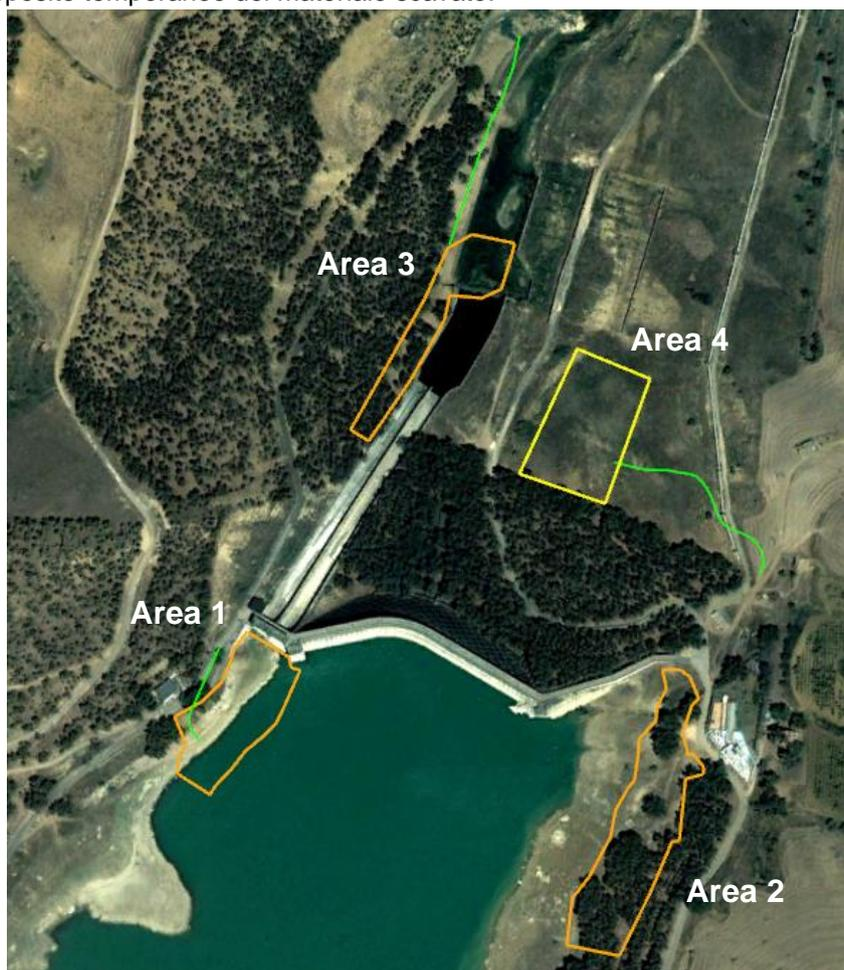
Figura 2-29. Organizzazione delle aree di cantiere, in verde le piste di cantiere
