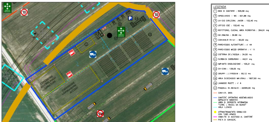
Figura 61: Layout cantiere operativo CO 01
