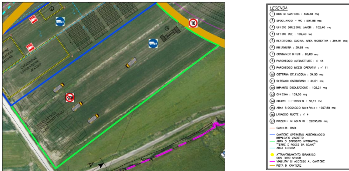
Figura 62: Layout cantiere operativo CO 02
