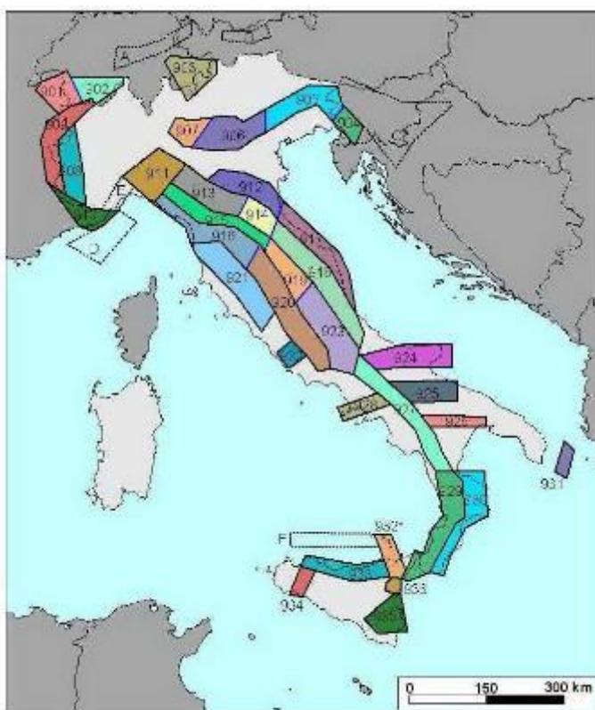
Figura 3 - Zonazione sismogenetica del territorio nazionale (INGV, 2004). I limiti di colore blu separano zone con analogo significato cinematico, che differiscono principalmente per le caratteristiche di sismicità.
