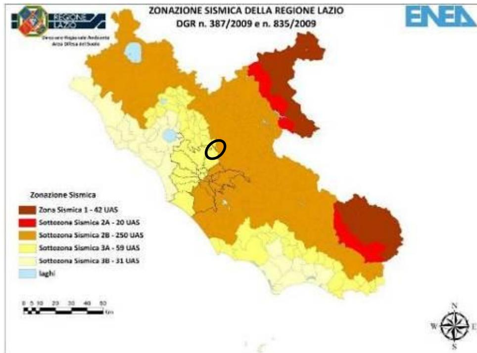
Figura 12 - Nuova Classificazione Sismica della Regione Lazio secondo il DGR n. 387/2009 e n. 835/2009 con ubicazione dell'area in esame
