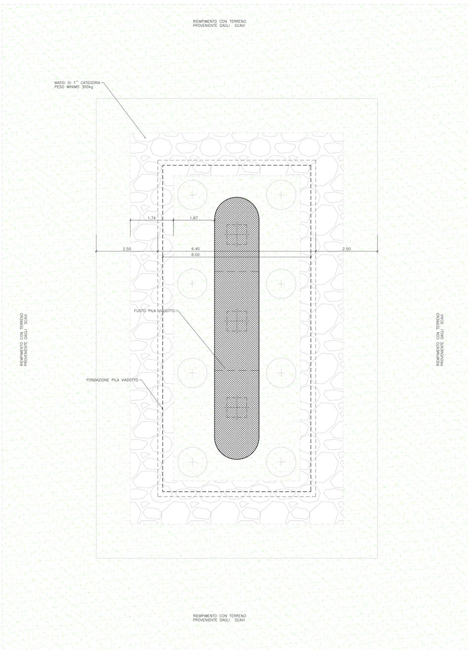
SEZIONE TRASVERSALE TIPO DI PROTEZIONE FONDAZIONI PILE
