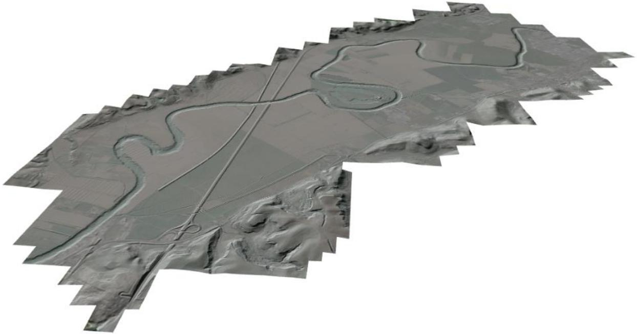
Figura 24 - Modello Digitale del Terreno utilizzato per la modellazione bidimensionale, dato dalla sovrapposizione di batimetria e rilievo lidar
