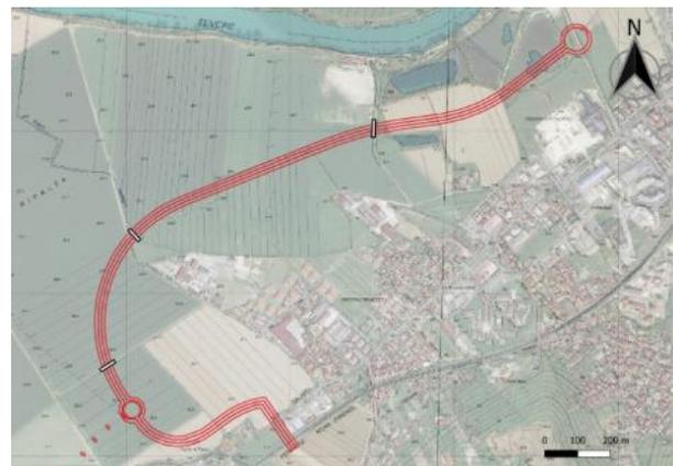
Figura 2: schema dell'arginatura per la messa in sicurezza idraulica dei territori oggetto di studio
