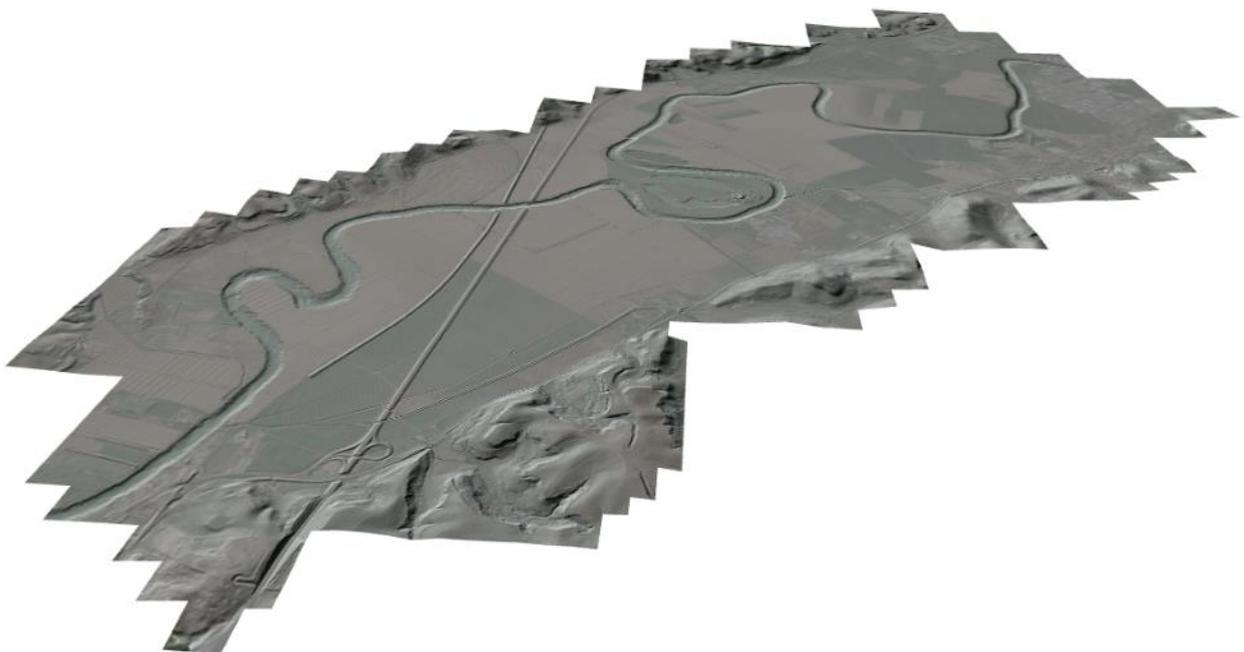
Figura 13 - Modello Digitale del Terreno utilizzato per la modellazione bidimensionale, dato dalla sovrapposizione di batimetria e rilievo lidar
