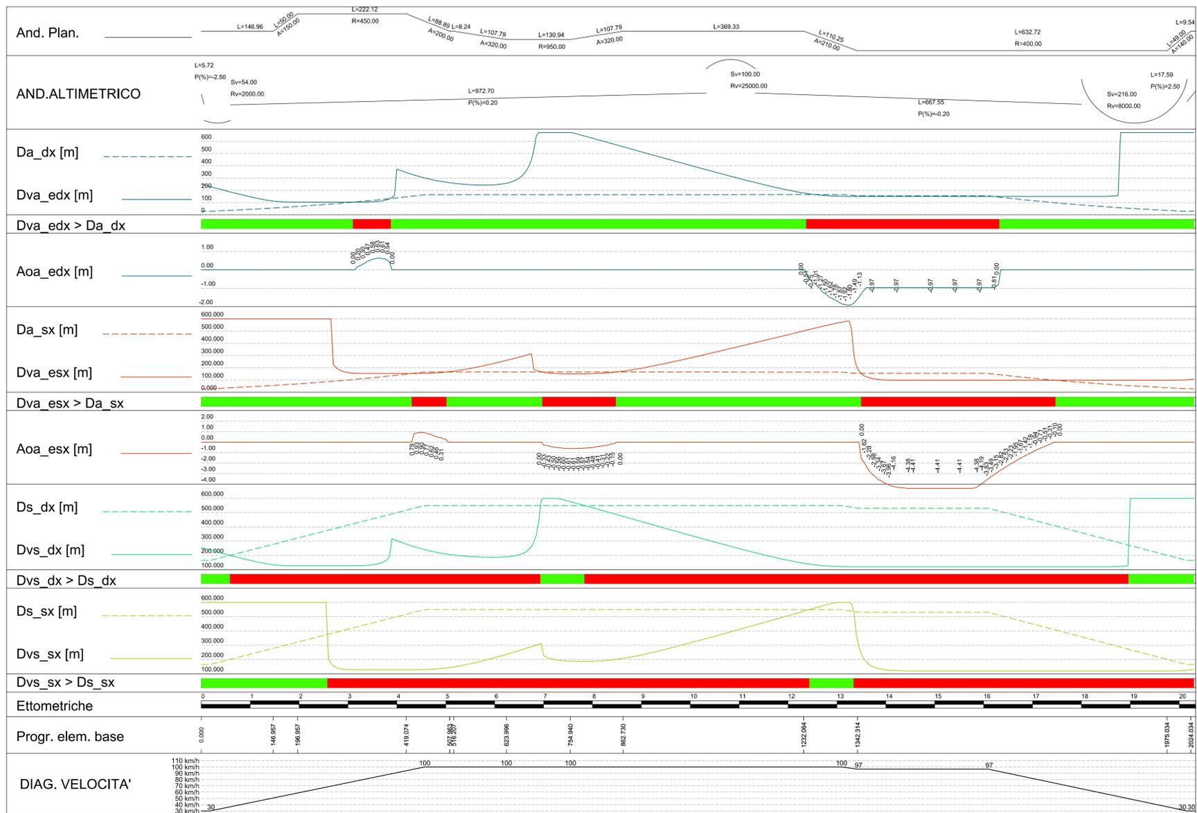
NOTA: Gli allargamenti della sede stradale indicati nel diagramma di visibilità sono stati recepiti. Si rimanda alle sezioni trasversali e alle planimetrie di progetto.
