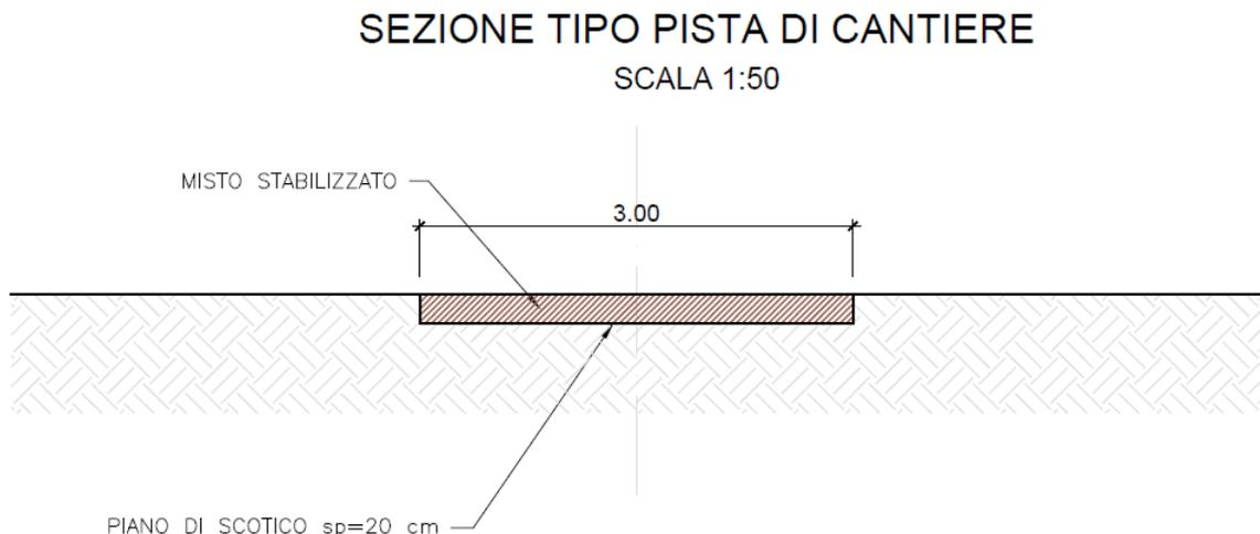
Figura 5-1 Sezione tipo pista di cantiere.
