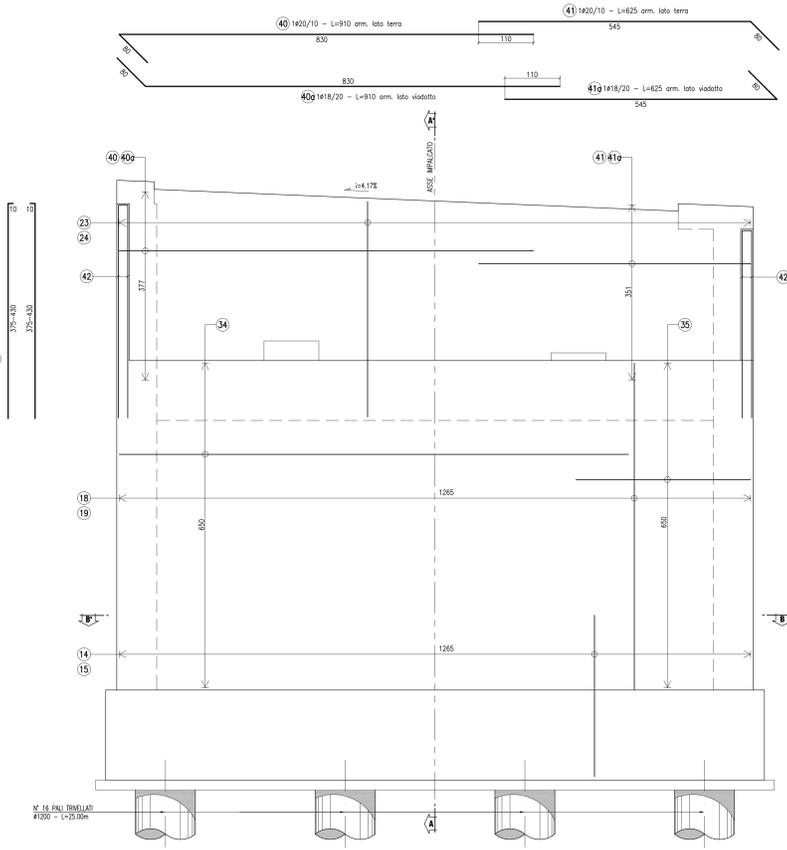
**ARMATURA SPALLA SpB (Carreggiata Dx)**
