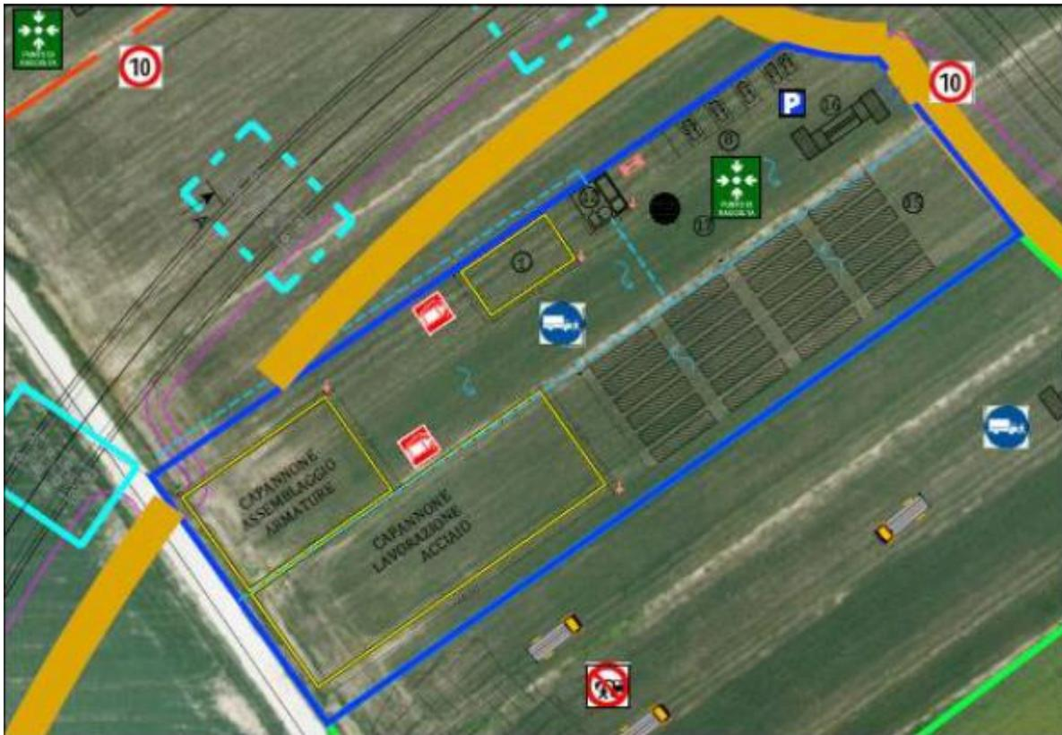
Figura 13 - Localizzazione area di cantiere CO01
