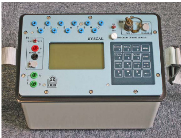
Figura 11 - Georesistivimetro IRIS Syscal Pro a 96 canali
