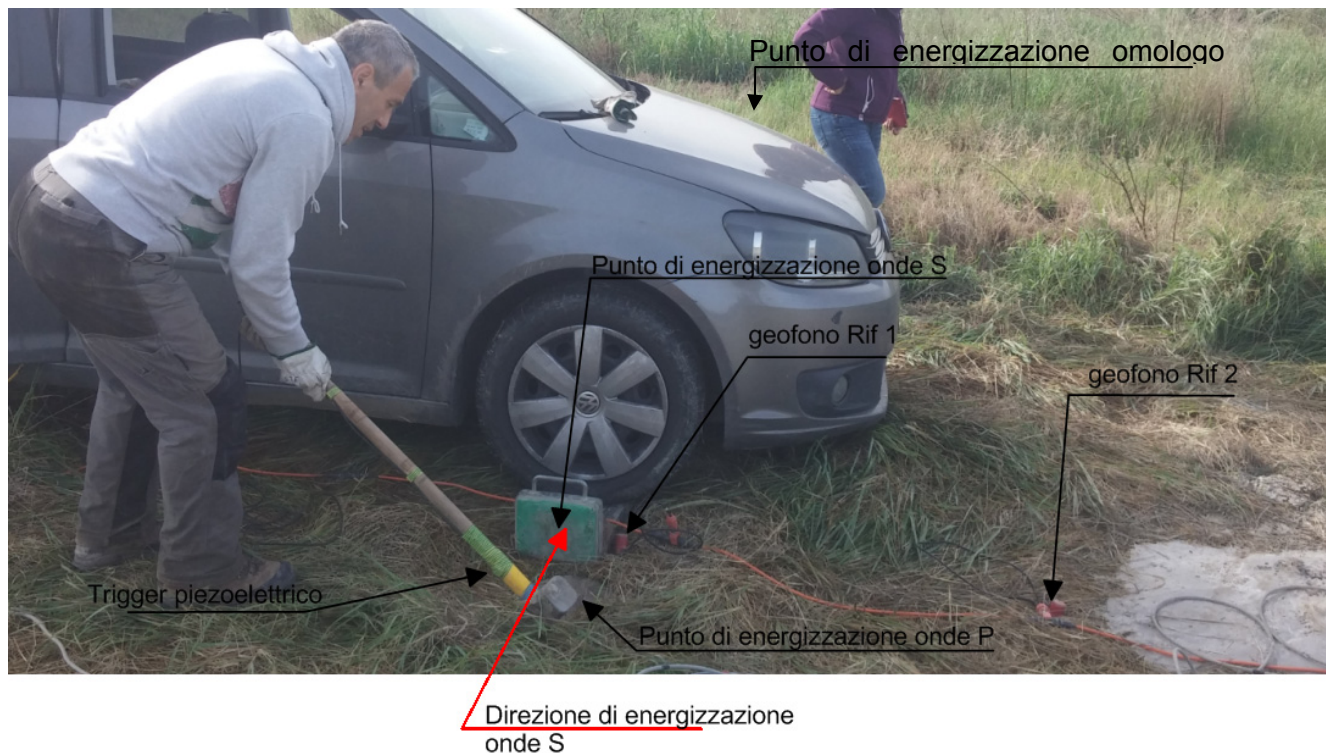
Figura 1 Immagine degli apparati di energizzazione
