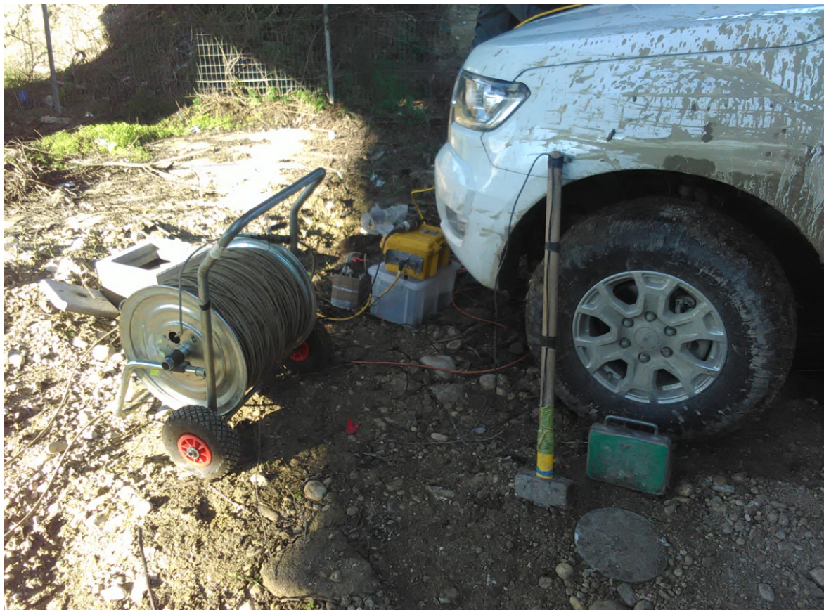
Particolare indagini geofisiche: down hole nel sondaggio S4 Pz
